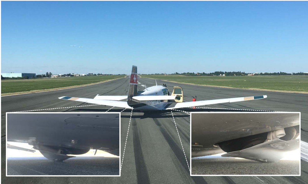
Abbildung 1: Aufnahme der HB-DFO nach der Landung auf Piste 03 in Poitiers (LFBI) mit teilweise ausgefahrenem Fahrwerkbein links und rechts
