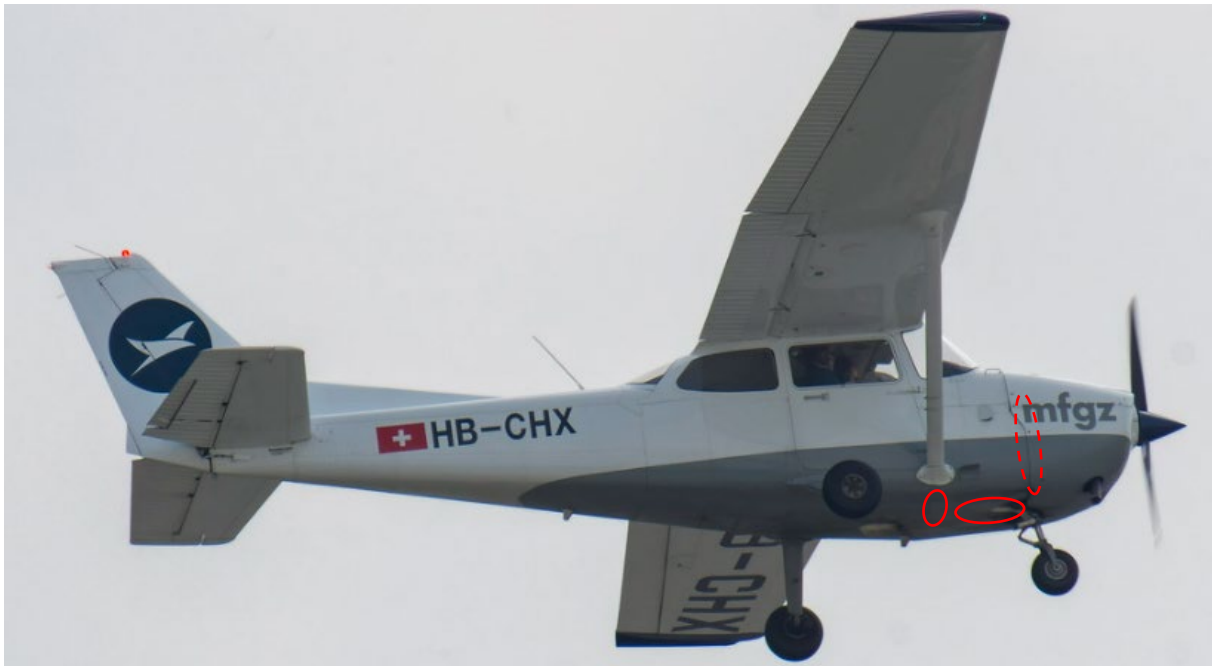
Abbildung 2: Bereiche mit den von aussen festgestellten Verformungen (rote Ellipsen) zur Veranschaulichung. Die gestrichelte rote Ellipse zeigt den Bereich des Brandspantes auf, der innenseitig sowohl auf der linken und der rechten Seite verformt war. Quelle: Internet (flickr.com)
