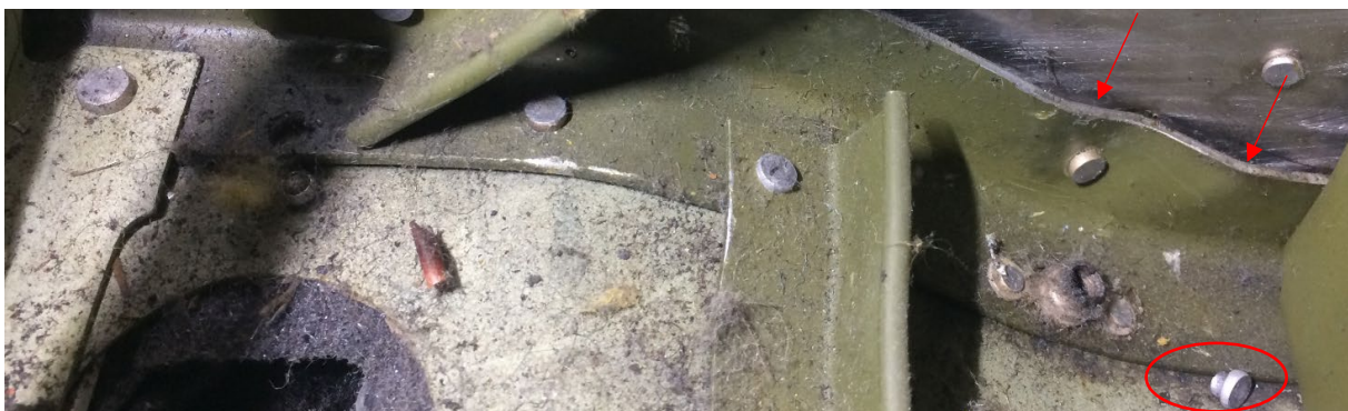
Abbildung 4: Verformungen (rote Pfeile) und geborstene Niete (rote Ellipse). Ähnliche Schadensbilder wurden in verschiedenen Bereichen der Rumpfstruktur festgestellt.
