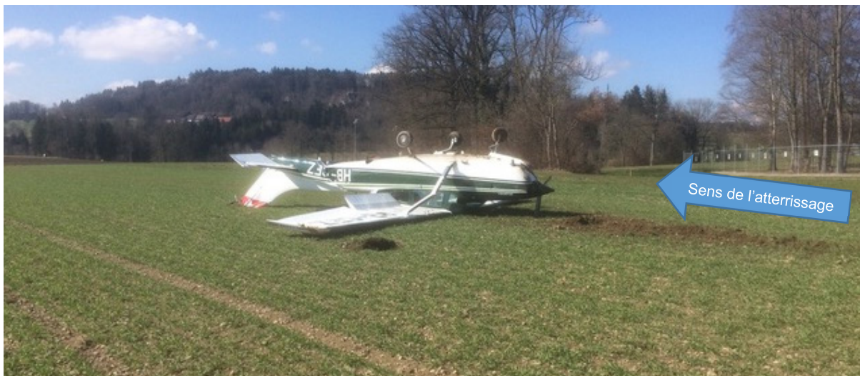
Abbildung 1: Endlage des stark beschädigten Flugzeugs HB-CFZ nach dem Überrollen der Piste. Die Spuren am Boden zeigen die Richtung der Landung an.
