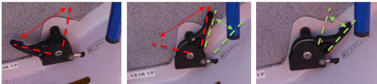
Figura 2: Posizioni della leva del gas: minimo (a sinistra), posizione nella quale la valvola a farfalla ha iniziato a muoversi (al centro), massimo (a destra). In rosso è indicato il campo in cui la valvola a farfalla non seguiva il movimento della leva e rimaneva nella posizione del minimo. In verde è indicato il campo in cui la valvola a farfalla seguiva il movimento della leva del gas.
