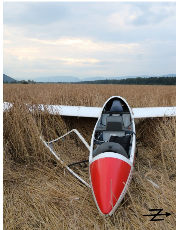
Abbildung 2: Rumpfvorderteil der HB-3214 mit vollständig abgetrennter Kabinenhaube; westliche Blickrichtung
