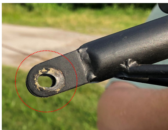
Abbildungen 4 und 5: Links ist (rot-eingekreist) das ausgeschlagene Lager der Gasfeder sichtbar (vgl. Abbildung 1, roter Pfeil); rechts lässt sich (gelb-eingekreist) der Bruch in der rechten Stahlrohrhalterung erkennen (vgl. Abbildung 1, gelber Pfeil).
