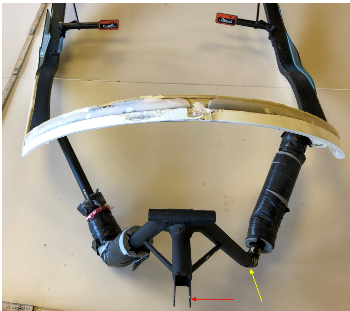
Abbildung 3: Aus der HB-3099 ausgebauter, beschädigter hinterer Haubenrahmen: An der rechten Stahlrohrhalterung ist der Schaumstoff-Schutz bereits nach vorne geschoben, wodurch der Bruch sichtbar wurde (gelber Pfeil). Das ausgeschlagene Lager der Gasfeder befindet sich beim roten Pfeil.
