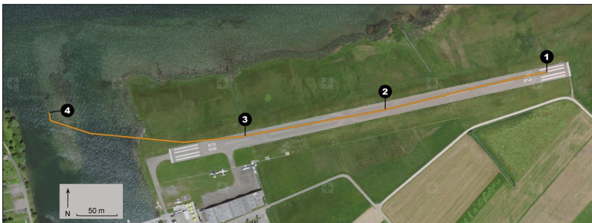
Abbildung 1: Flugplatz Wangen-Lachen mit der 500 m langen Piste und GPS-Flugwegaufzeichnung der HB-2033 (orange Linie). Der Punkt ❶ bezeichnet die Startposition bei der Pistenschwelle 26. Bei Punkt ❷ wurde eine Geschwindigkeit über Grund von 70 km/h erreicht und bei Punkt ❸ hob das Flugzeug ab. Punkt ❹ bezeichnet die Endlage nach der Notlandung im See. Quelle der Basiskarte: Bundesamt für Landestopografie.
