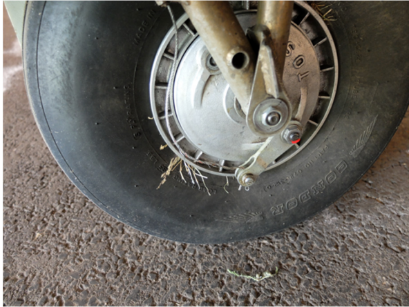
Abbildung 1: Einziehfahrwerk der HB-1593 mit defektem Betätigungsseilzug
