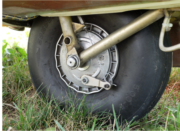
Abbildung 2: Einziehfahrwerk einer DG 202 mit korrekter Einstellung des Betätigungsseilzuges
