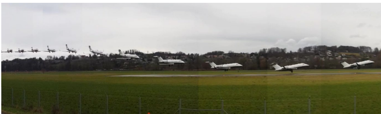
Abbildung 1: Videoaufnahme eines Passanten vom Durchstart der G-XONE über dem vor der Landeschwelle gelegenen Bereich der Piste 14 (elf in einem zeitlichen Abstand von jeweils einer Sekunde auseinanderliegende Einzelaufnahmen, kombiniert zu einer Abbildung).
