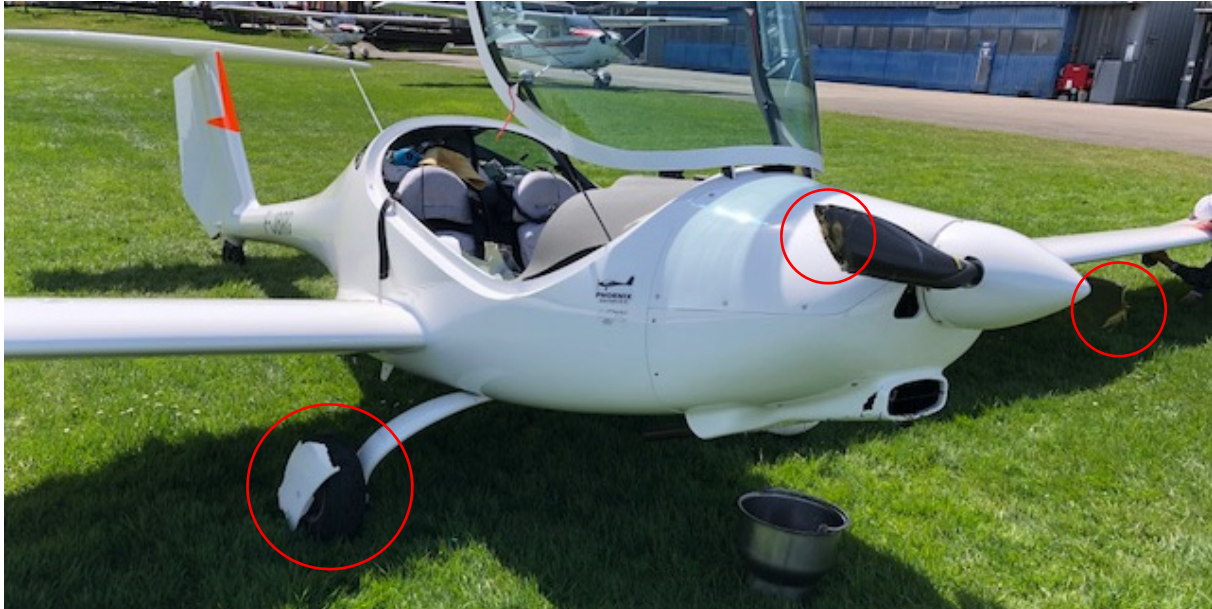
Abbildung 1: Die Beschädigungen (rote Kreise) am Motorsegler des Modells Phoenix Air U-15 nach der Landung.
