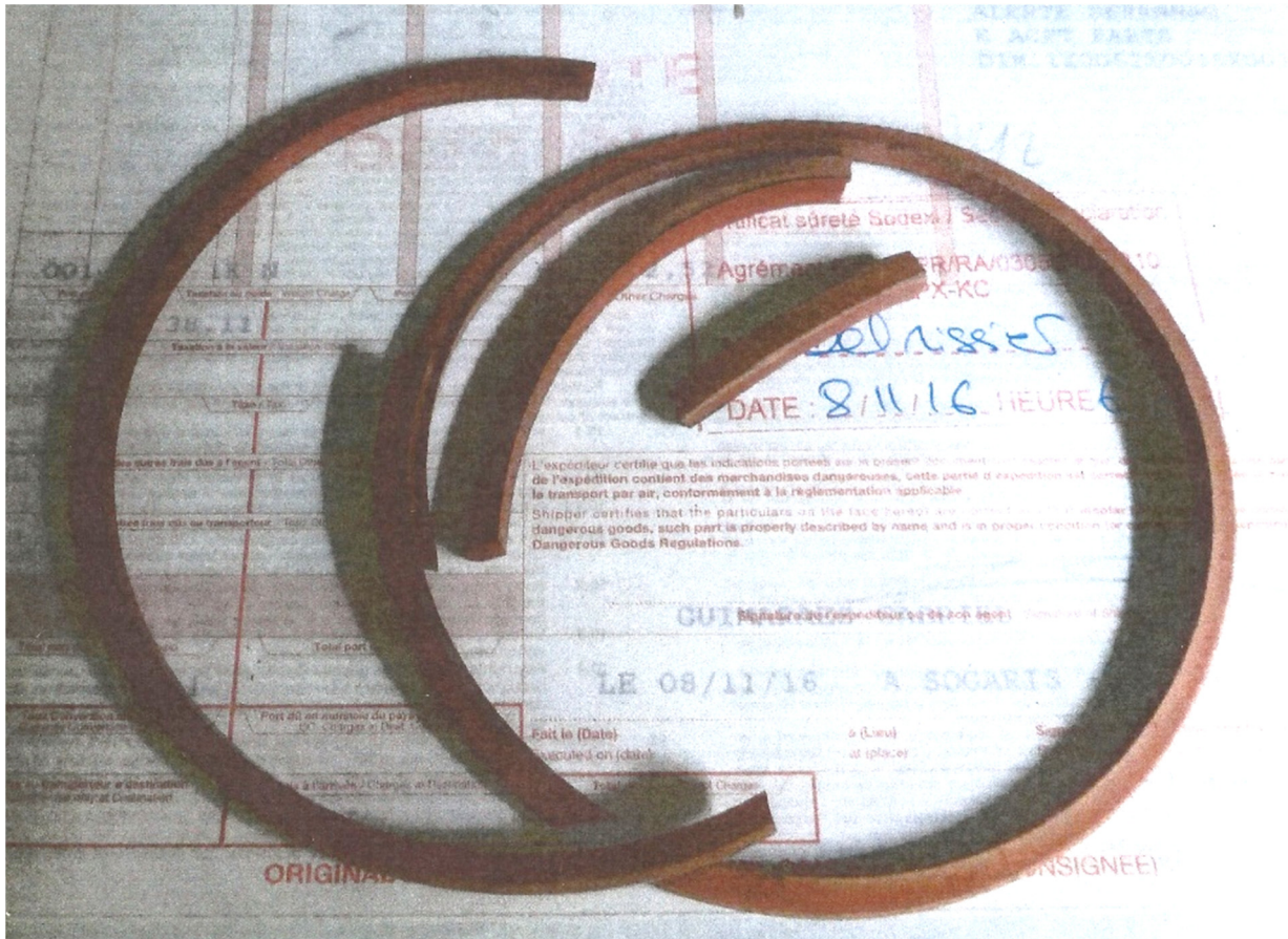
Figure 5 : Joint défectueux à l'origine de la fuite d'air comprimé chaud
