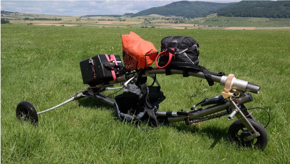
Abbildung 1: Fahrgestell mit abgedeckten Antriebskomponenten und Rettungssystem
