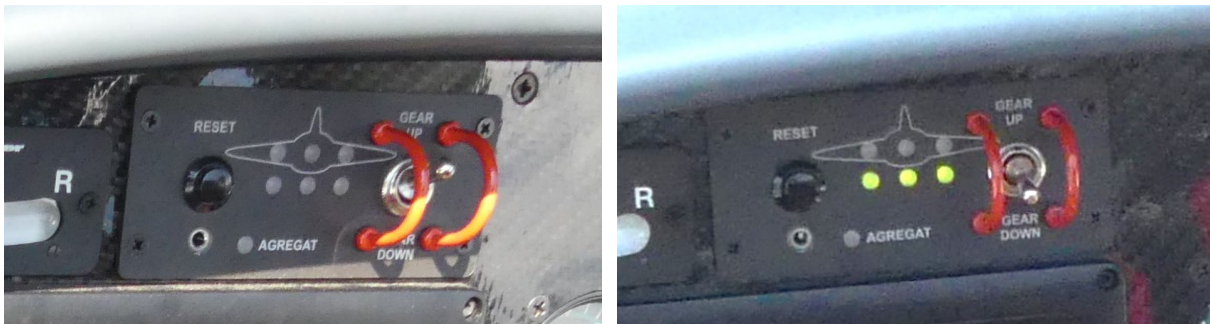
Abbildung 3: Fahrwerksanzeige und elektrischer Fahrwerksschalter der D-MPCS: links unmittelbar nach dem Unfall (mit ausgeschalteter Stromversorgung), rechts nach dem Anheben des Rumpfbuges und Ausfahren des Bugfahrwerkes.
