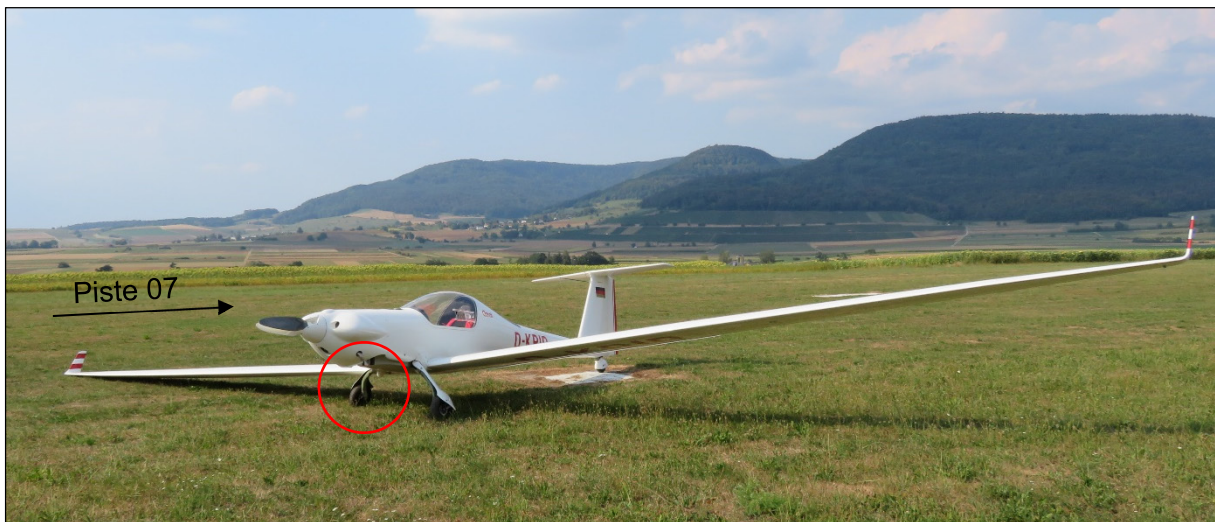
Abbildung 1: Endlage der D-KRID etwas ausserhalb des rechten Pistenrandes 07 des Flugfeldes Schaffhausen (LSPF) mit nach hinten abgedrehtem, rechtem Hauptfahrwerk (rot eingekreist).
