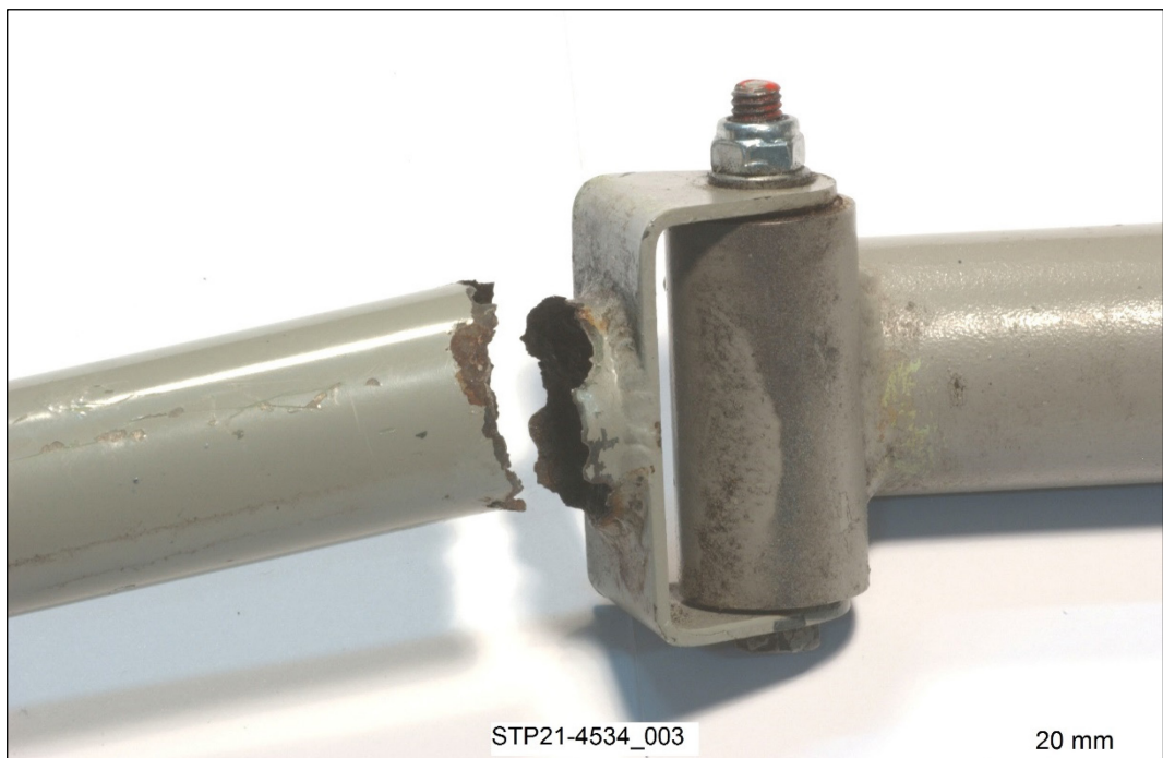
Abbildung 6: Bruch des Stahlrohres des rechten Steuerknüppels oberhalb der Schweissnaht bei der Gelenkgabel.
