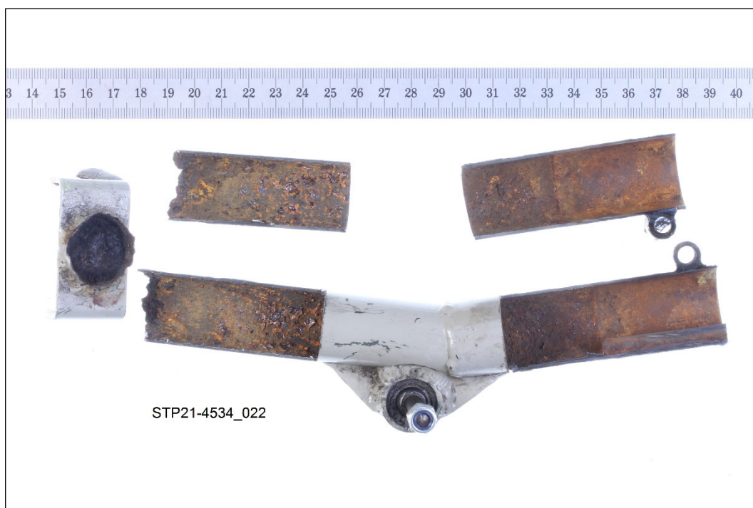
Abbildung 10: Aufgetrennter unterer Teil des rechten Steuerknüppels.
