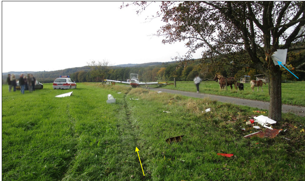
Abbildung 2: Endlage der D-KDEU in Flugrichtung gesehen. Rechts der Baum, mit dem die rechte Tragfläche kollidierte (blauer Pfeil), und in der Mitte die Spur des Einrad-Hauptfahrwerks im Wiesland (gelber Pfeil).
