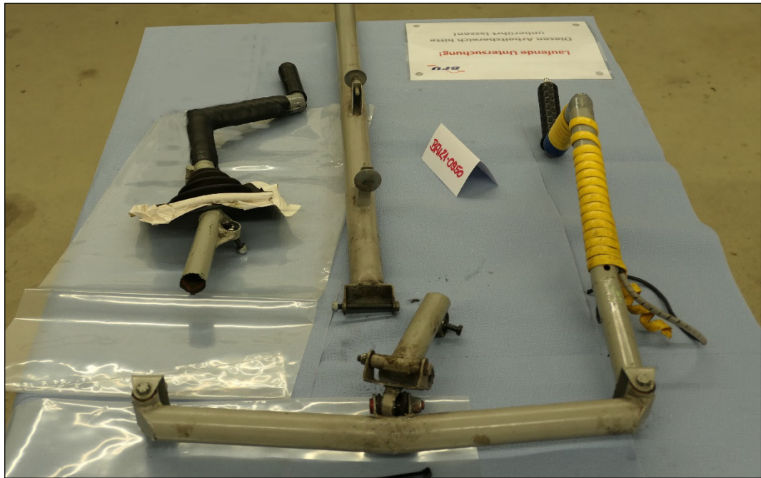
Abbildung 5: Übersichtsbild der Steuerorgane für Quer- und Höhenruder mit dem gebrochenen rechten Steuerknüppel (linke Bildseite, vgl. auch roter Pfeil in Abbildung 3).
