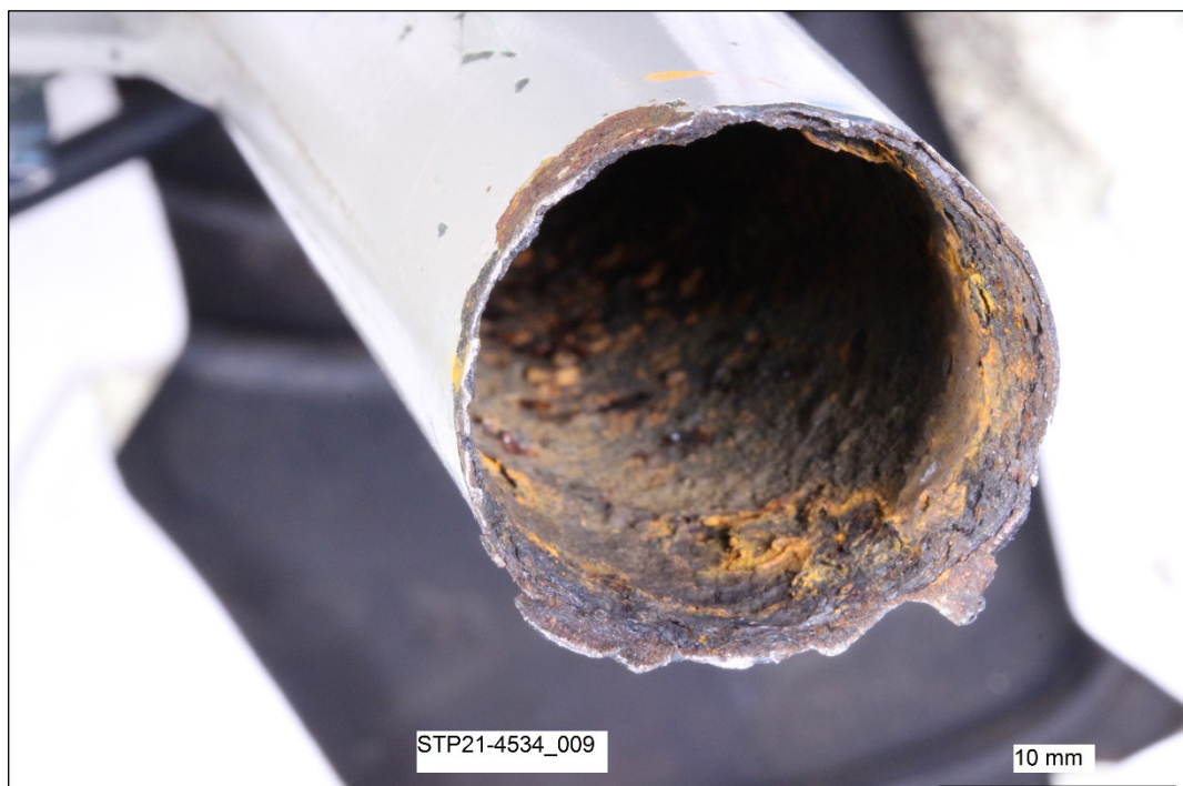
Abbildung 8: Bruchstelle des Stahlrohres des rechten Steuerknüppels mit stark korrodierter Rohrinnenoberfläche.
