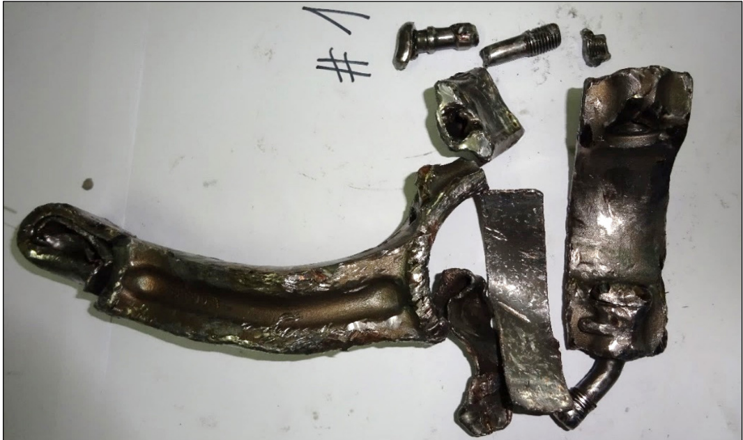
Abbildung 2: Gebrochener und deformierter Pleuel des Zylinders #1.
