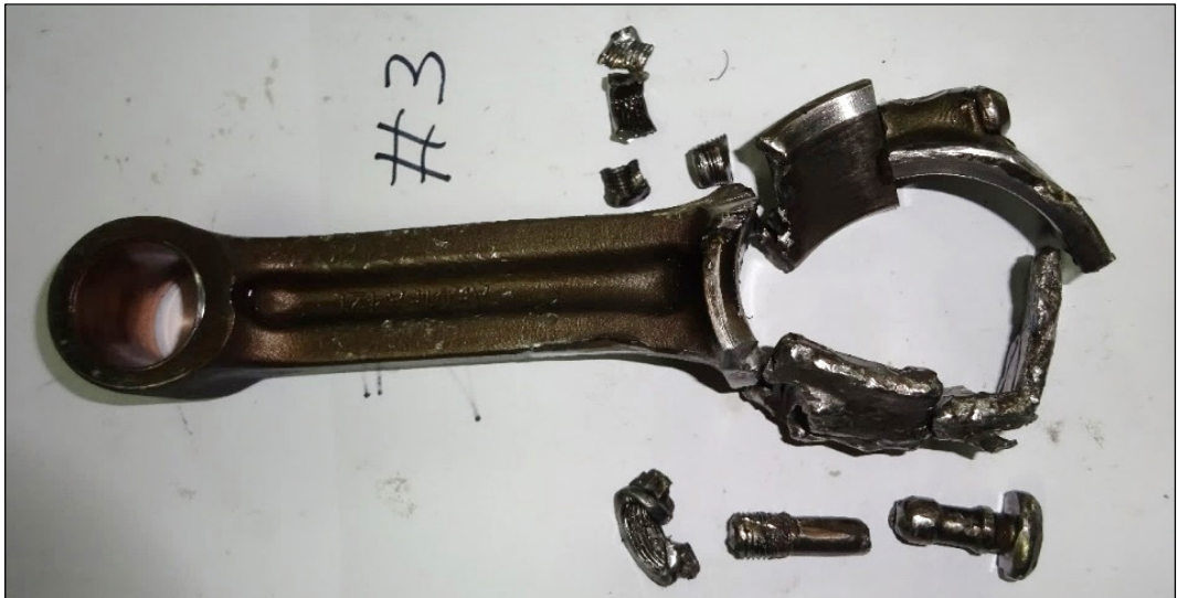
Abbildung 3: Gebrochener und deformierter Pleuel des Zylinders #3.
