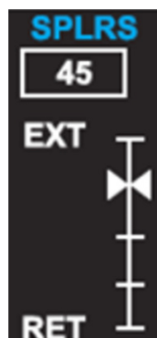
Figure 5 : Détail de la représentation synoptique des déporteurs
