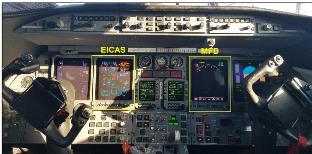
Figure 3 : Disposition des écrans de visualisation EICAS et MFD
