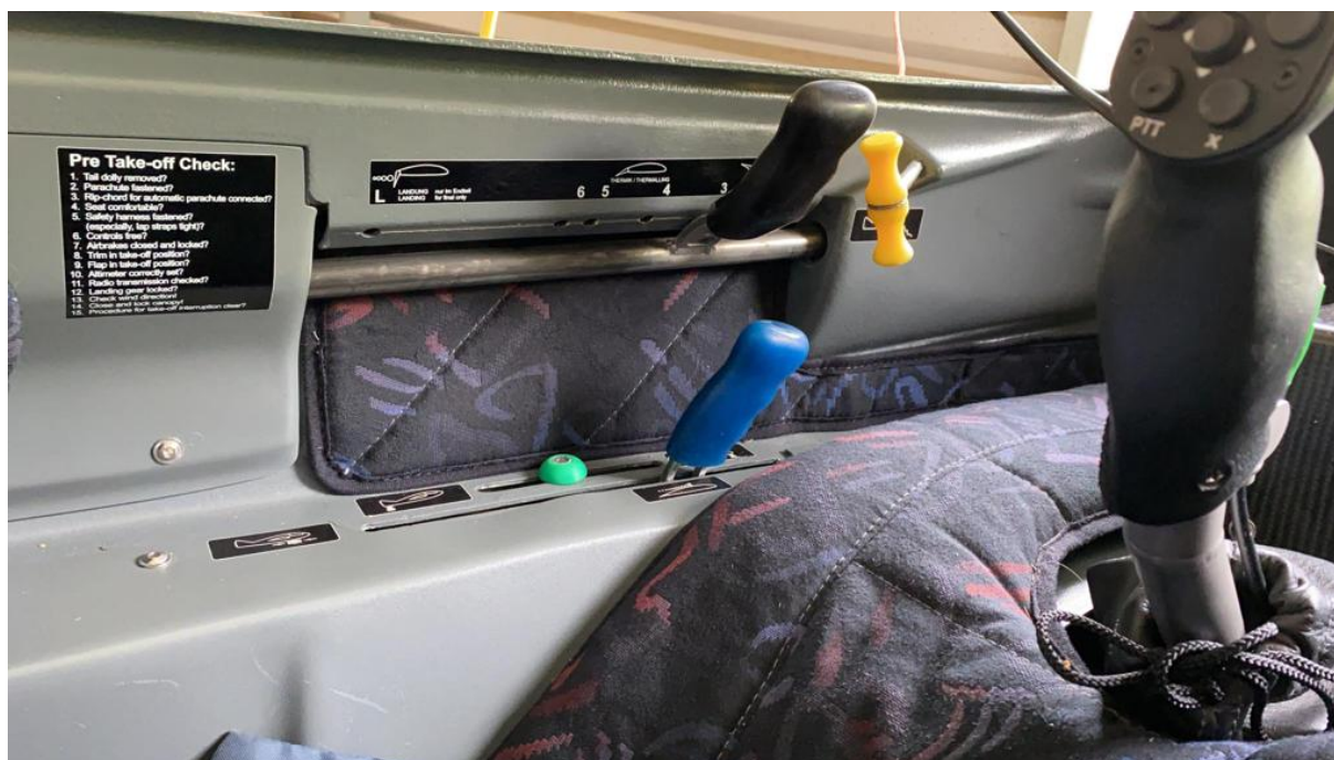
Figure 1: Représentation du côté gauche du cockpit avec la commande noire des volets en haut et la commande bleue des aérofreins en bas.
