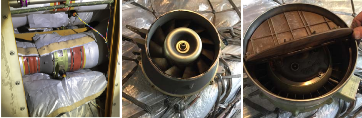
Abbildung 3: Bild links: cooling fan an der linken Seitenwand im vorderen Frachtraum. Bild in der Mitte und rechts: ausgebauter cooling fan mit blockiertem Rotor (Fotos vom 19. November 2016 um 12:29 UTC)
