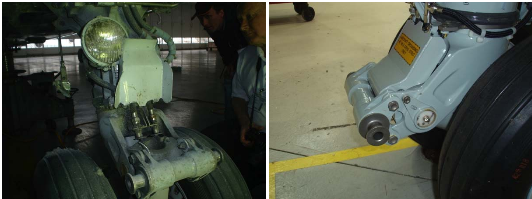
Abbildung 1: Links: WOW cover plate , wie sie nach dem Ausfahren des Bugfahrwerks vorgefunden wurde. Rechts: WOW cover plate im Normalzustand.
