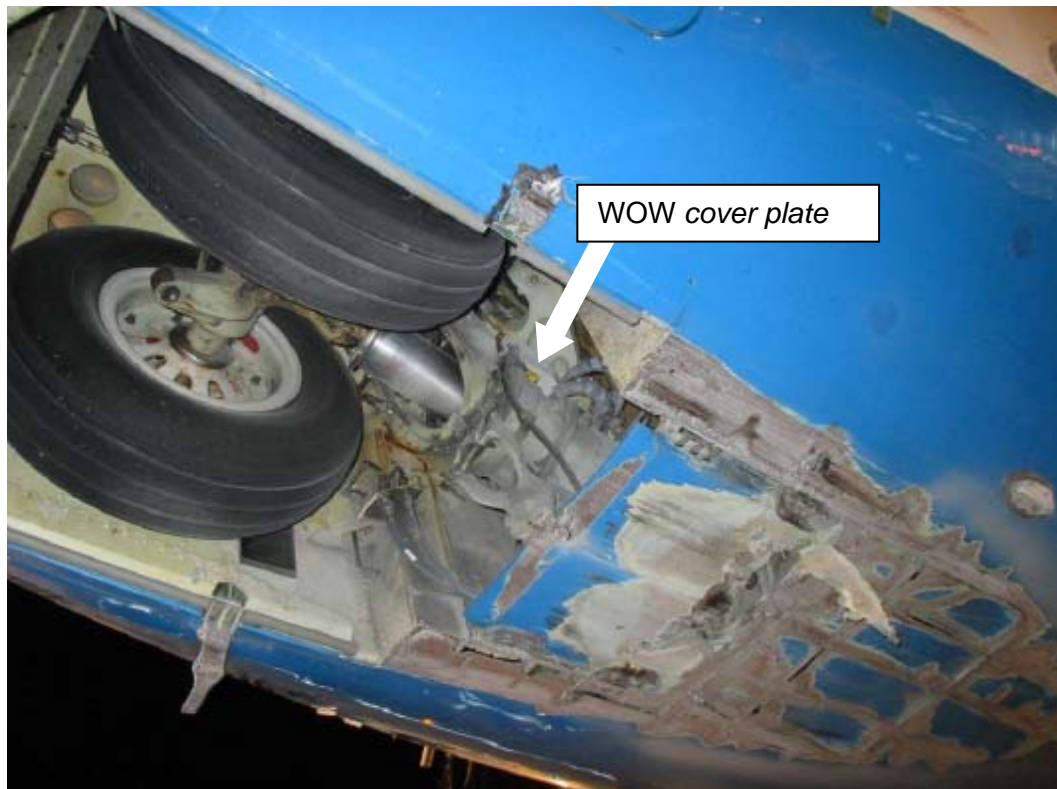
Abbildung 2: Die WOW cover plate des Bugfahrwerks eingeklemmt zwischen der unteren und oberen Knickstrebe ( drag strut ) des Bugfahrwerks. Diese Aufnahme wurde noch auf der Unfallstelle aufgenommen.
