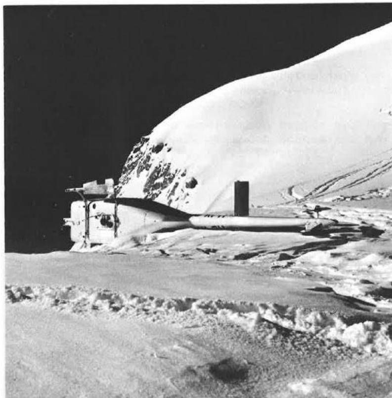
Unten: Endlage des Hubschraubers. Am rechten Bildrand oberhalb des Heckrotors Schleifspuren des Hauptrotors.
