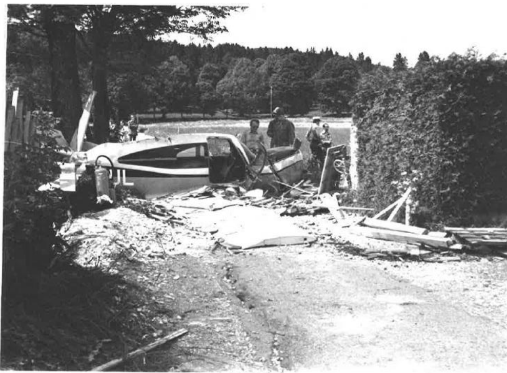
Position de l'épave en fin de course, après collision avec le mur d'un jardin.
