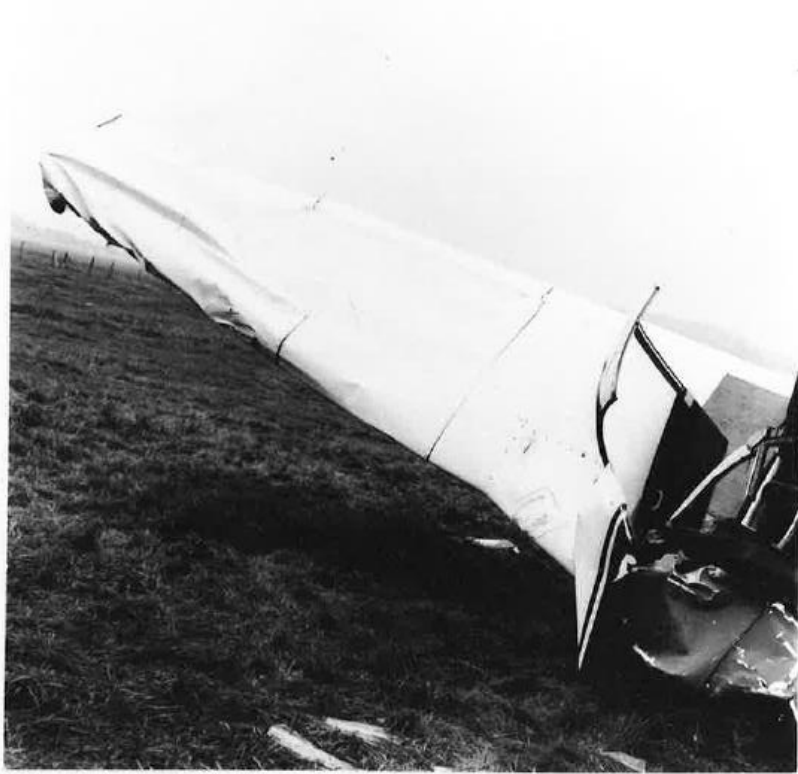
Point de contact aile droite Gardan / partie supérieure arrière fuselage Piper (déformations, déchirures et traces de couleur).
