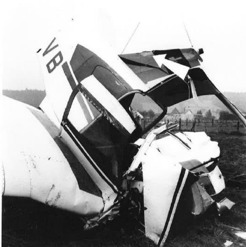
Point de contact dérive Gardan / bord de fuite extrémité aile gauche Piper ( déformations, déchirures et traces de couleur).
