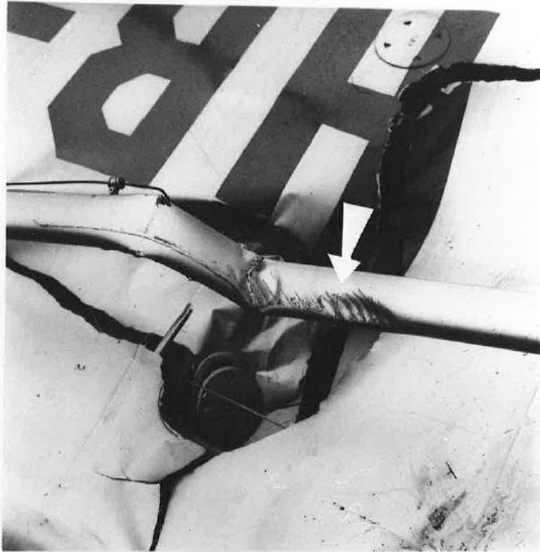
Point de contact hauban aile gauche Piper / porte droite Gardan. Les éraflures sur le hauban ont été faites par les têtes des rivets du cadre de la porte.
