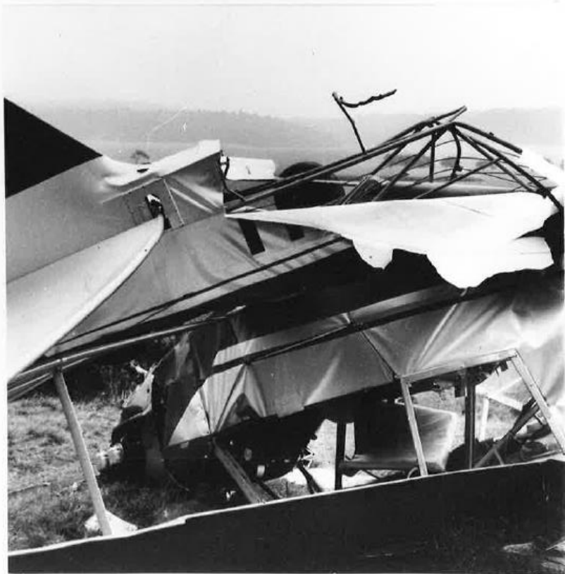
Point de contact aile droite Gardan / partie supérieure arrière fuselage Piper (déformations, déchirures et traces de couleur).
