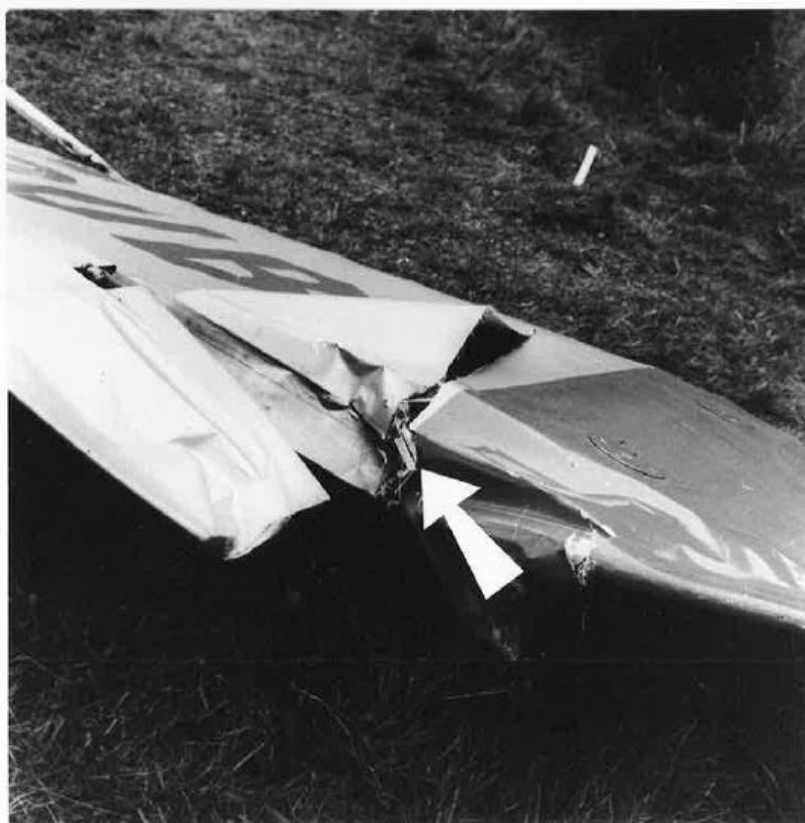
Point de contact dérive Gardan / bord de fuite extrémité aile gauche Piper ( déformations, déchirures et traces de couleur).
