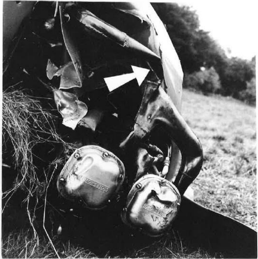
Photo du haut: coup d'hélice relevé sur la tubulure d'échappement du Piper.
