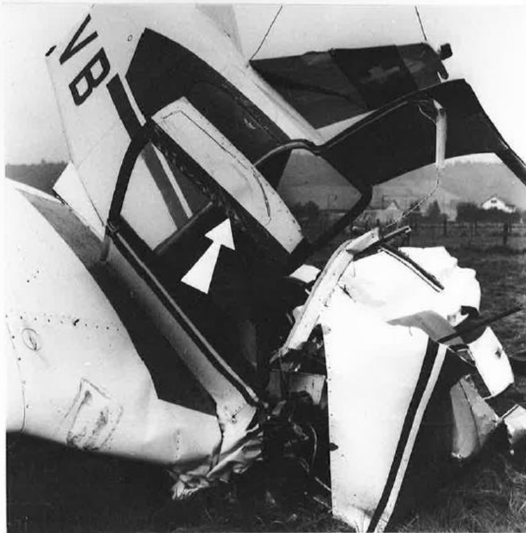
Point de contact hauban aile gauche Piper / porte droite Gardan. Les éraflures sur le hauban ont été faites par les têtes des rivets du cadre de la porte.
