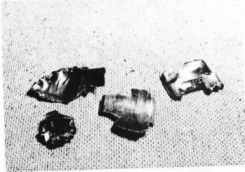
Bruchstücke der zu dünnem Blech ausgewalzten Lagerschalen von Pleuellager No. 2
