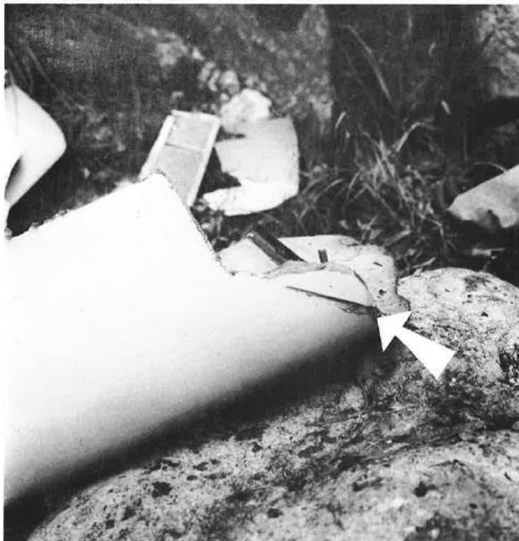
Abgerissene Nasenbeplankung des rechten Flügels mit Kabelspur
