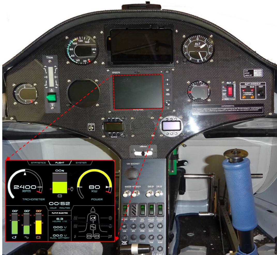
**Figure 4** : tableau de bord du HB-SAA avec l'EPSI (délimité par le traitillé rouge, source : Pipistrel). La page principale de l'EPSI est illustrée sous forme agrandie (les valeurs ne sont pas corrélées).
