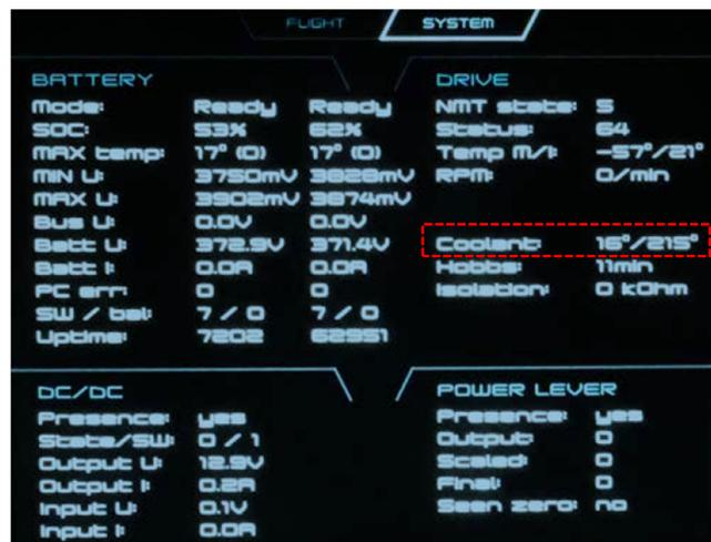
**Abbildung 5:** Systemseite mit verschiedenen Parametern der Antriebseinheit, unter anderem mit den Temperaturen der Kühlflüssigkeit (*coolant*, rot umrandet), Quelle: Pipistrel.
