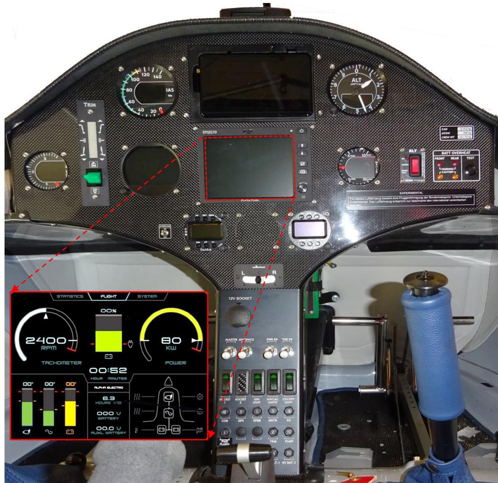
**Abbildung 4:** Instrumentenbrett der HB-SAA mit EPSI (rot gestrichelt, Quelle: Pipistrel). Die Hauptseite des EPSI ist vergrößert symbolisch dargestellt (Werte korrelieren nicht).
