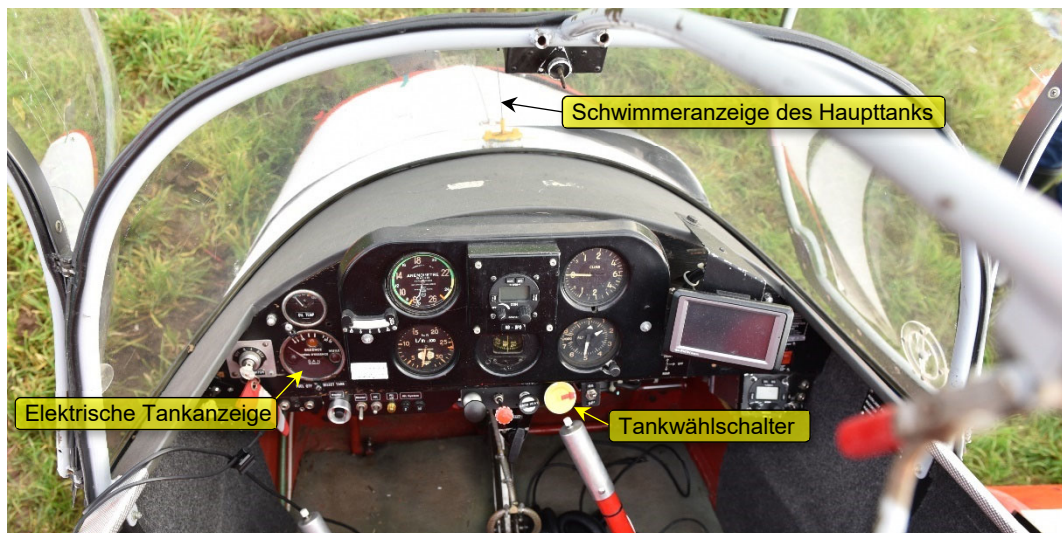
Abbildung 3: Tankanzeigen und Tankwählschalter der HB-SPO
