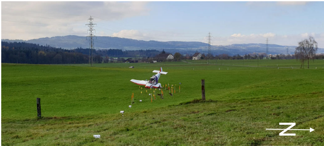
Abbildung 2: Endlage der HB-SPO nach der Notlandung mit Blickrichtung nach Westen. Im Vordergrund markiert sind die auf der Wiese zurückgelassenen Spuren.
