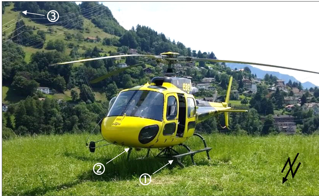
Figure 3 L'hélicoptère HB-ZGV après son atterrissage de précaution induit par la collision avec le câble. Tôle de raccordement intérieure tordue au niveau du patin d'atterrissage gauche ① et revêtement du fuselage présentant des traces d'abrasion venant du câble de fibre optique ②. En haut à gauche de l'image se trouve le sommet du pylône électrique n° 107 ③, où était fixée l'une des extrémités du câble de fibre optique.
