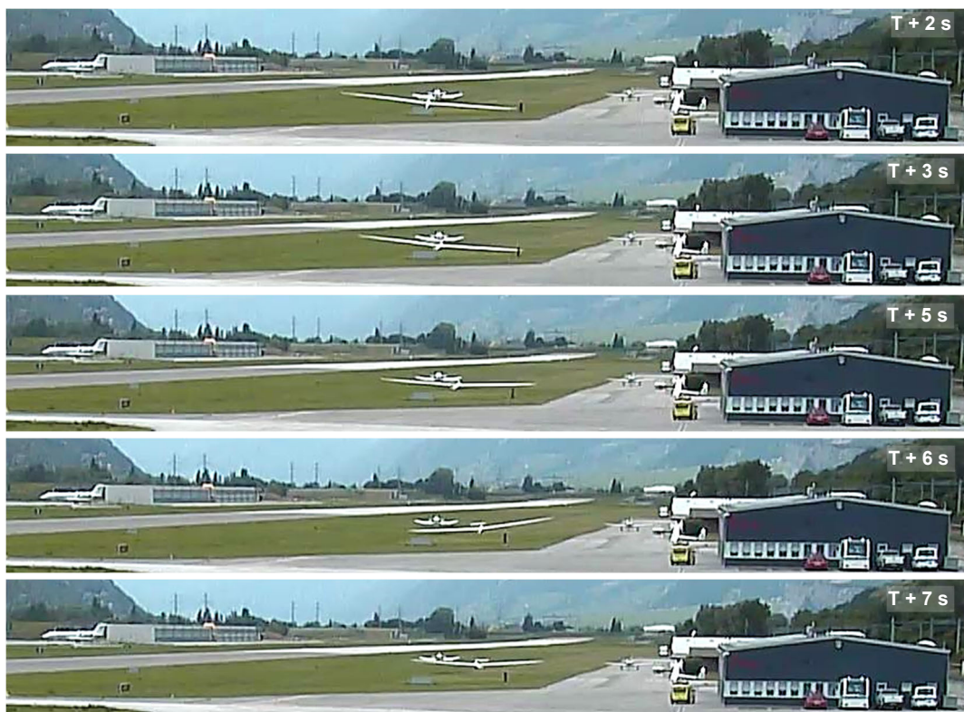
Figure 2 : Séquences de photos du vol de remorquage en phase de décollage en direction de l'ouest vers la fin de la piste 25. L'image du haut a été enregistrée juste après le commencement de roulage du planeur (temps T), après que l'aide de vol ait libéré l'extrémité de l'aile droite et que celle-ci ait touché le sol.
