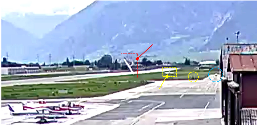
Abbildung 3: Ausschnitt aus einem Standbild einer Videosequenz in westlicher Blickrichtung zum Pistenende 25, rund 23 Sekunden nach dem Beginn des Startvorganges (Zeitpunkt T, vgl. Abbildung 2) und kurz vor dem Aufprall des Segelflugzeuges (roter Pfeil und Rahmen); Schleppflugzeug (gelber Pfeil und Rahmen), Flügelmann (gelber Kreis), geparktes Flugzeug auf dem nördlichen Vorfeld (blauer Kreis).
