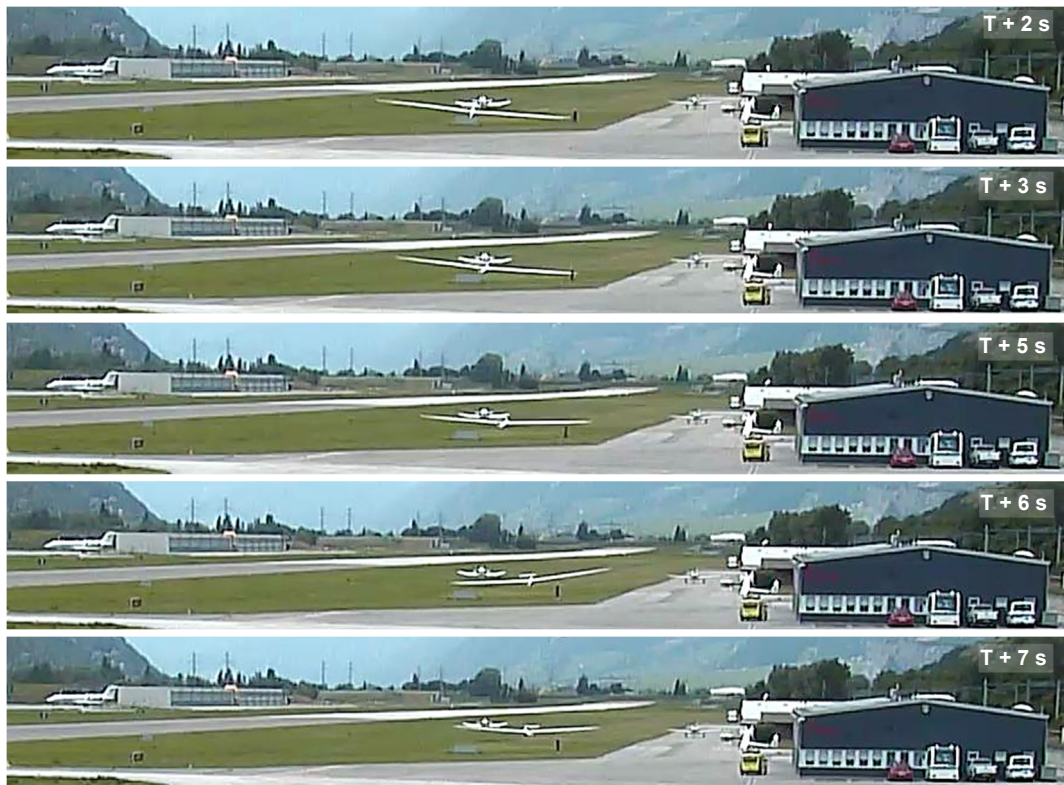
Abbildung 2: Aufnahmesequenz des Schleppzuges beim Startlauf in westlicher Richtung zum Pistenende 25. Das oberste Bild, unmittelbar nach dem Anrollen des Segelflugzeuges (Zeitpunkt T), wurde aufgenommen, nachdem der Flügelmann die rechte Flügelspitze losgelassen und diese den Boden berührt hatte.
