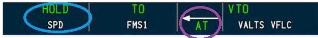
**Abbildung 8:** TLA > 23°, AT ist im *thrust* HOLD-Modus, > 60 KIAS
