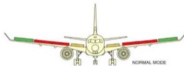
Aus unseren Büchern (FCOM1) ist bekannt, dass das FBW der C Series eine sogenannte «Ground Lift Dumping (GLD)» Funktion bereitstellt. Wie der Name erahnen lässt, besteht die Aufgabe dieser Funktion darin, nach der Landung den Auftrieb der
