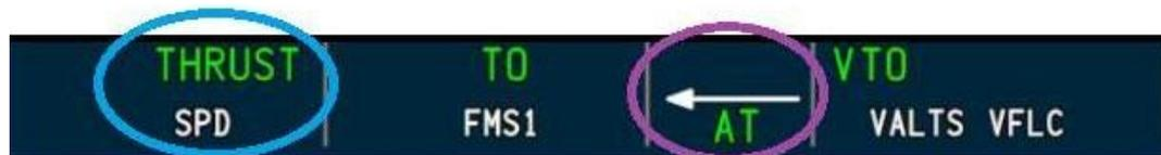
**Abbildung 7:** TLA > 23°, AT ist im THRUST-Modus aktiviert (*engaged*), < 60 KIAS
