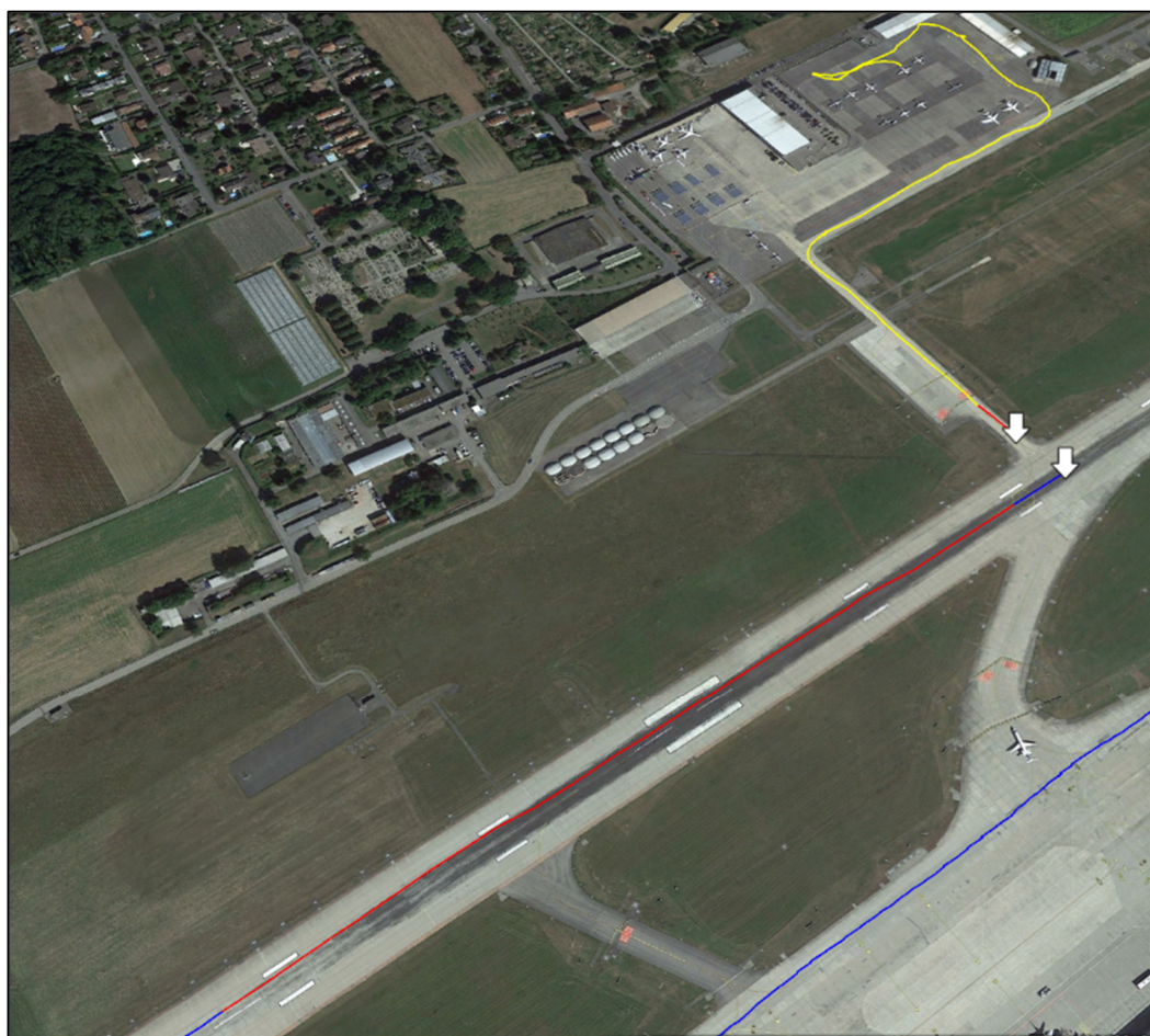
Figure 1 : trajectoires de N990FV (jaune) et EIN68N (bleu). Les parties représentées en rouge indiquent lorsque l'alarme parlée « RIMCAS » était émise.
