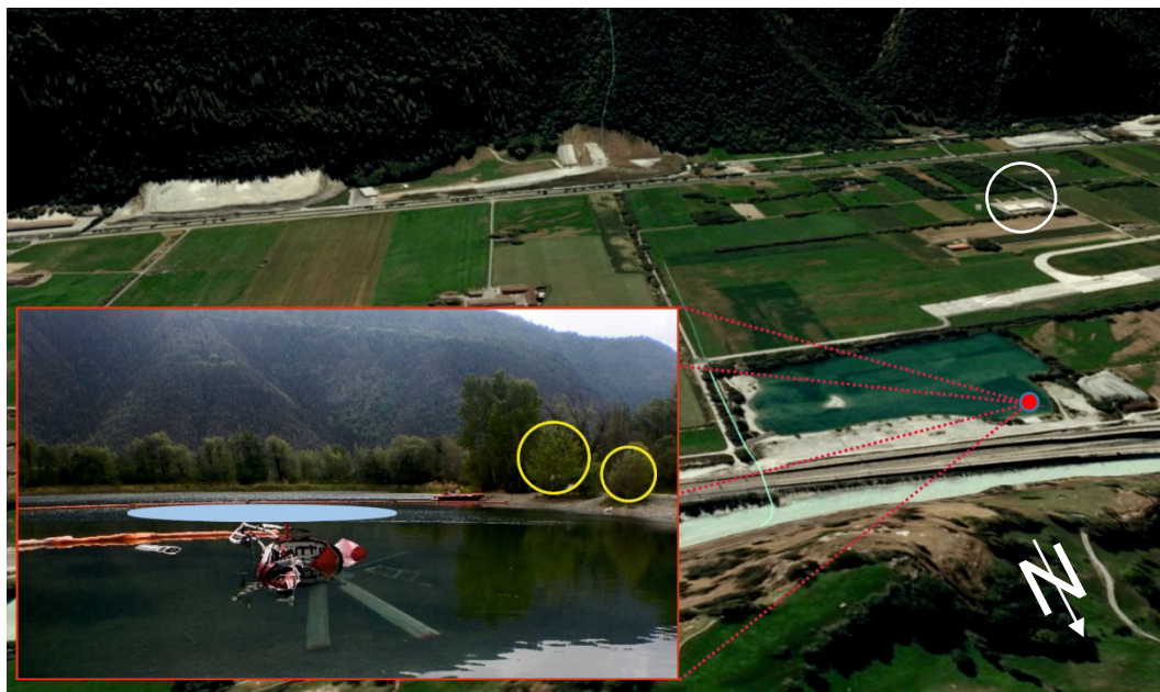
Abbildung 3: Endlage der HB-ZKF (roter Punkt) im Steineji See, rund 600 m nordöstlich des Heliports Raron (weisser Kreis). Die Tiefe des Baggersees beträgt an der Wasseraufnahmestelle (blau gefärbt) mehrere Meter. Als horizontale Sichtreferenz dienten dem Piloten die beiden Bäume (gelbe Kreise) am westlichen Ufer.
