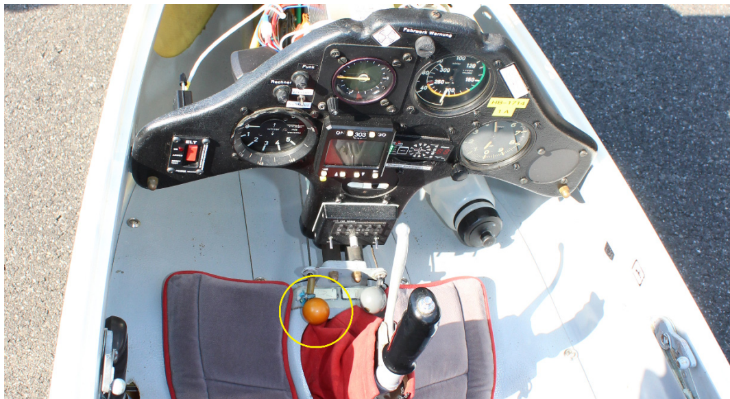
Abbildung 2: Cockpit des Segelflugzeugs mit dem gelben Betätigungsknopf für die Klinkvorrichtung (Kreis) und dem rechts daneben liegenden, grauen Betätigungsknopf für die Verstellung der Seitensteuerpedale.
