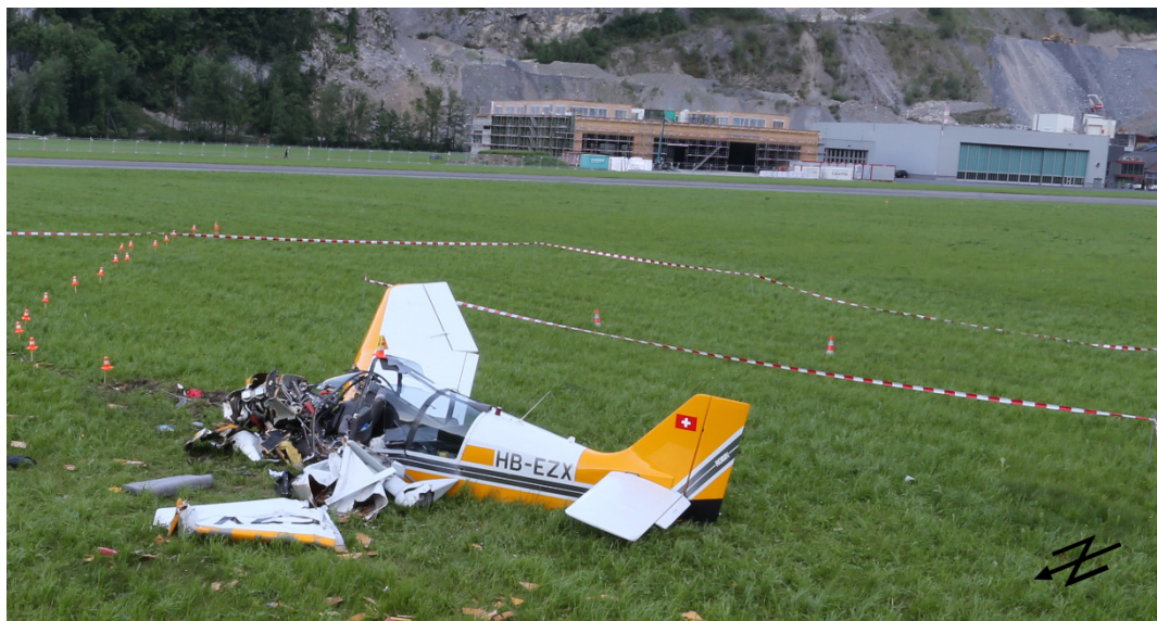
Abbildung 1: Endlage des Schleppflugzeugs, Blickrichtung nach Südosten. Die Kegel auf der linken Bildseite markieren die Endlage des Schleppseils in der Wiese. Im Hintergrund ist die Piste sichtbar.
