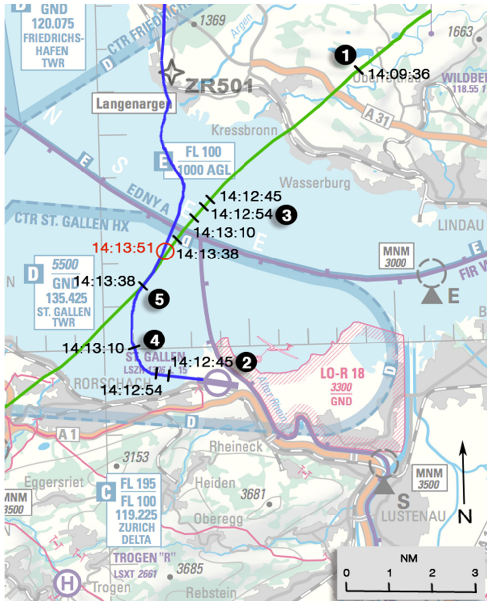
Abbildung 2: Flugwege der beiden Flugzeuge (NJE9LB: blau / HB-UCM: grün) mit folgenden Positionen: kleinste Annäherung (roter Kreis), Erstaufruf der HB-UCM („ abeam Lindau “) ①, Frequenzwechsel NJE9LB ②, Freigabe zum Durchqueren der Kontrollzone HB-UCM ③, Aktivierung des STCA ④, Aktivierung der TCAS-Warnung ⑤.
