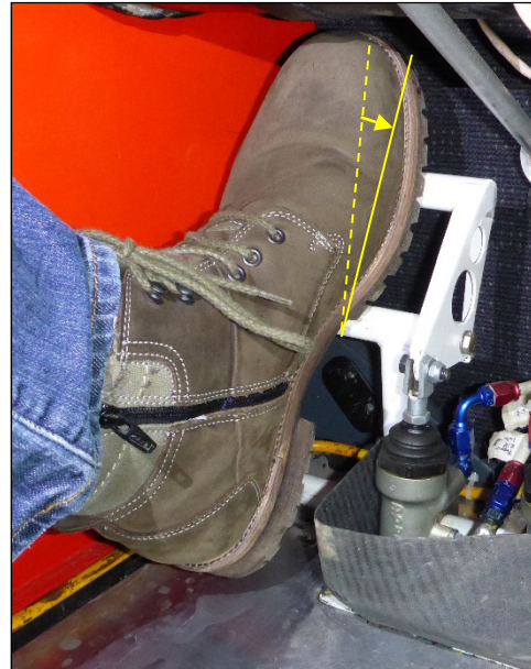
Abbildung 7: Zur Betätigung des Bremspedals muss die Fussspitze nur wenig nach vorne gedrückt werden (gelber Pfeil). Die Bremswirkung tritt bereits bei einer sehr geringen Auslenkung des Bremspedals ein.
