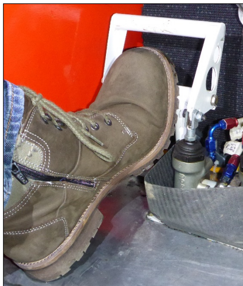
Abbildung 4: Fussposition mit zurückgezogener Ferse; die Fusssohle liegt nur auf dem Seitenruderpedal, aber nicht auf dem Bremspedal auf.
