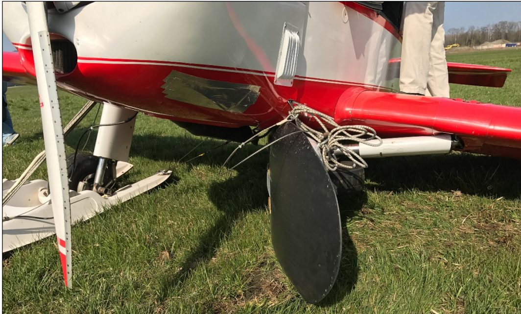
Abbildung 10: Endlage der HB-SEW: Geknicktes linkes Hauptfahrwerk mit ersichtlichen Beschädigungen am linken vorderen Rumpf und am linken Flügel.
