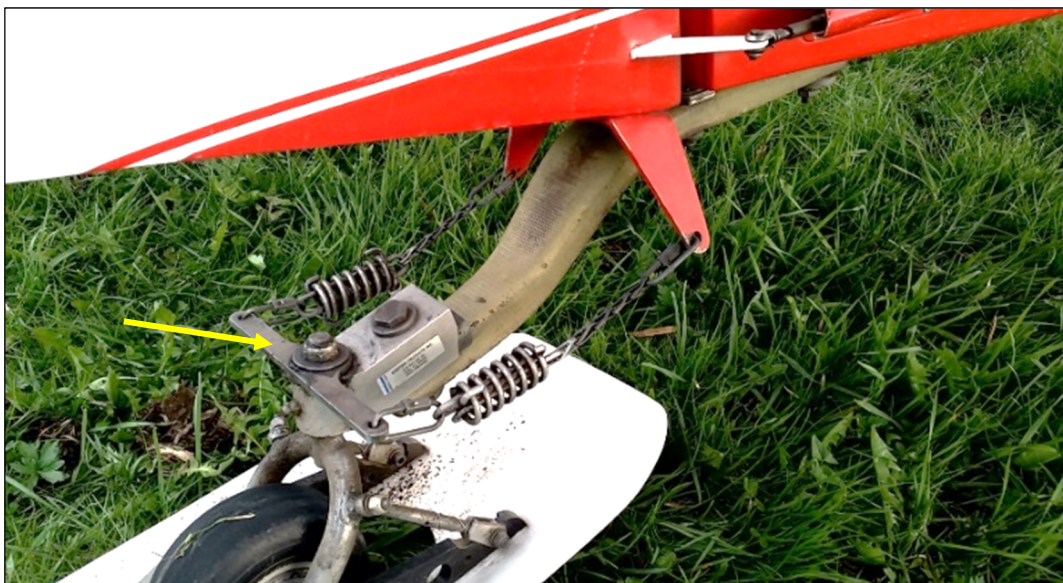
Abbildung 8: Heckradfahrwerk mit Lenkhebel (gelber Pfeil) der HB-SEW
