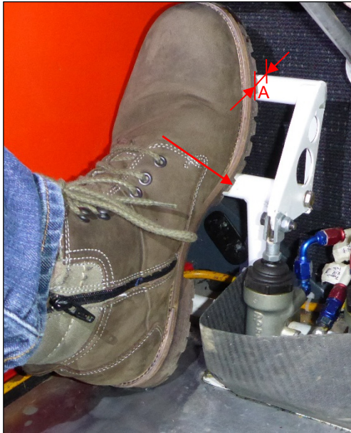
Abbildung 6: Fussposition, bei der das Bremspedal betätigt werden kann: Die Fusssohle liegt auf dem Seitenruderpedal auf (roter Pfeil). Trotz stark angewinkeltem Fuss ist der Abstand (A) zwischen Fusssohle und Bremspedal nur gering.
