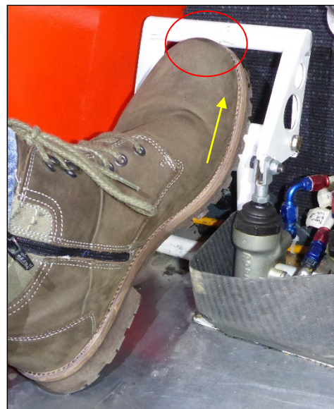
Abbildung 5: Beim Hochschieben des Fußes (gelber Pfeil) steht die Fussspitze ohne Anheben der Fusssohle am Quersteg des Bremspedals an (roter Kreis).
