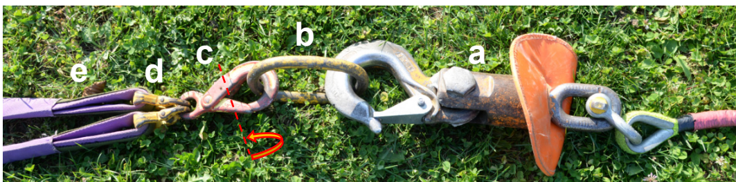
Abbildung 4: Das Zweiergehänge bestehend aus zwei zusätzlichen violetten Rundschlingen (e) mit je einer Nennt Tragfähigkeit ( Working Load Limit – WLL) von 1000 kg und dem Sicherheitshaken (c), der über einen zusätzlichen Ring (b) am Sekundärlasthaken (a) befestigt war. Der Sicherheitshaken (c) wurde um 180 Grad verdreht angebracht (Pfeil) und wurde somit nicht seinem ursprünglichen Verwendungszweck entsprechend verwendet (vgl. Kapitel 2.2.2).
