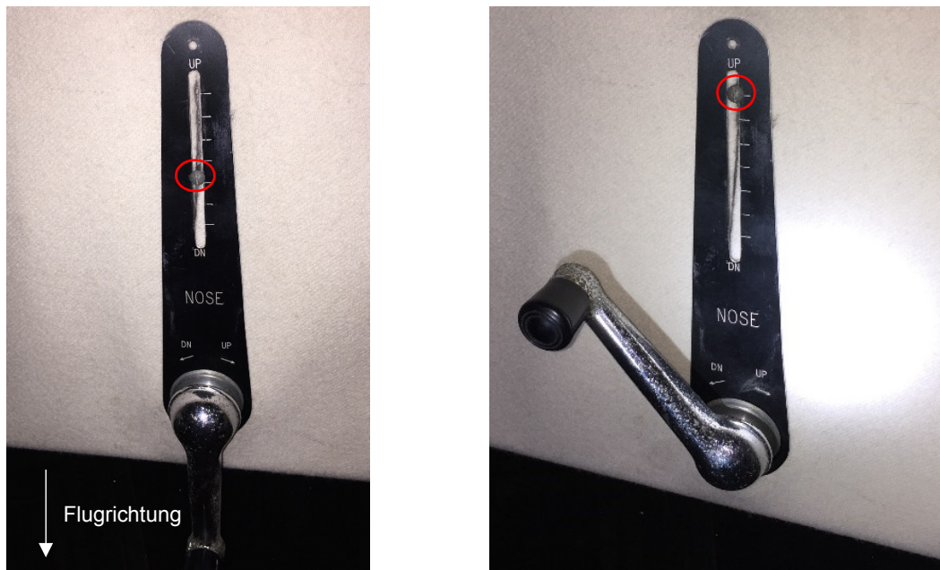
Abbildung 2: Ungefähre Position der Höhenruder-Trimmung vor dem Start (links) und nach dem Unfall (rechts)
