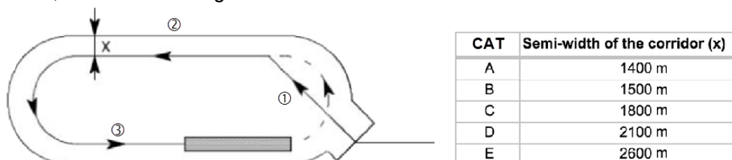
Figura 7: avvicinamenti con circuito sul campo ( circling ) con prue predefinite sul suolo ( prescribed tracks ) con il rispettivo semilargo corridoio ( semi-width of the corridor ), fonte: OACI Doc 8168 Vol. 2 (adattato dal SISI)
