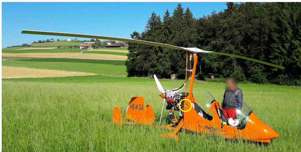
Figure 1: l'autogire HB-WGA sans bouchon de réservoir (cercle jaune) après l'atterrissage d'urgence, environ 1 km à l'ouest de l'aérodrome d'Ecuvillens (LSGE) vue en direction du nord.
