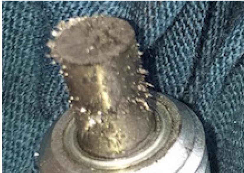
Figure 6: détecteur magnétique du moteur HB-WGA avec des particules métalliques.
