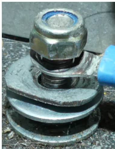
Abbildung 7: Gewindebolzen nach der Demontage des Reglergleichrichters mit den beschädigten Unterlagsscheiben und dem Kabelschuh des Massekabels
