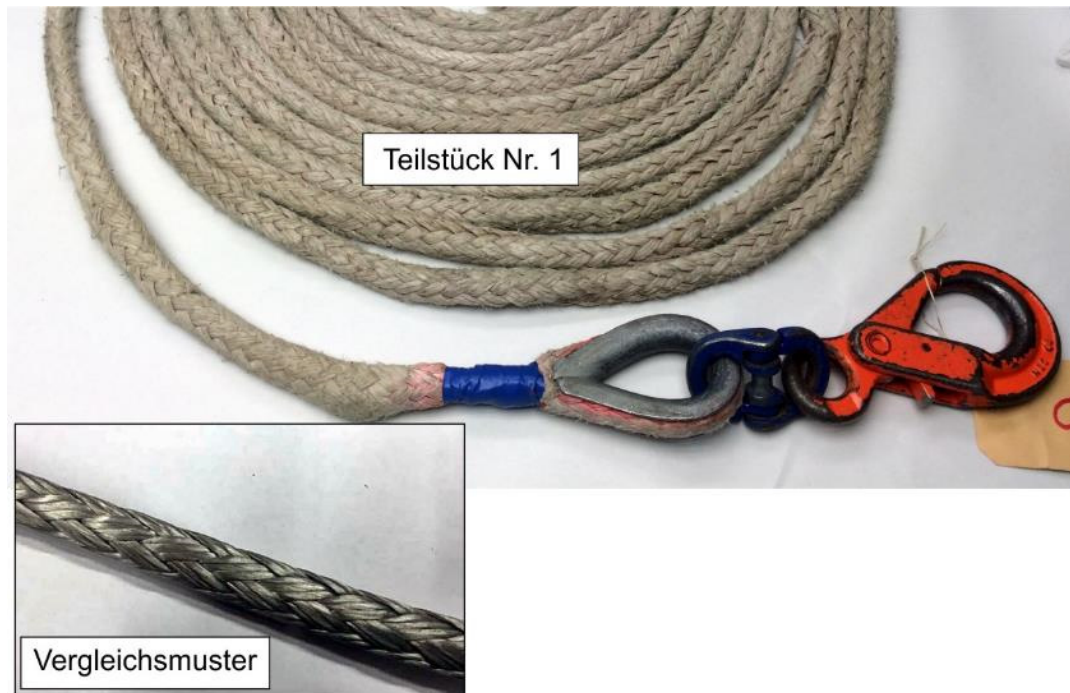
Abbildung 13: Teilstück Nr. 1 der 30 m Transportleine mit dem nicht korrekt verspleisst Ende. Das Vergleichsmuster zeigt den Zustand einer fabrikneuen Dyneema-Leine.
