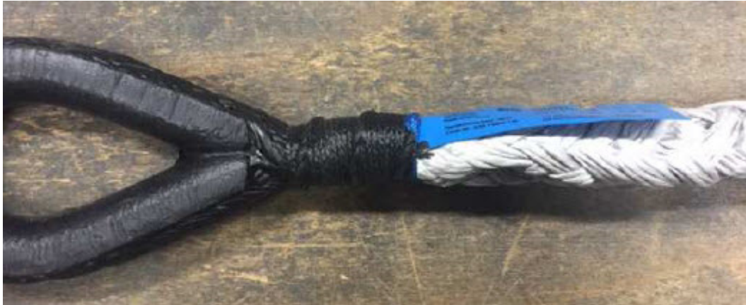
Abbildung 12: Beispiel eines Endes einer Transportleine mit Kausche und Etikette. Diese Leine verfügt ebenfalls über keinen Schutzmantel.
