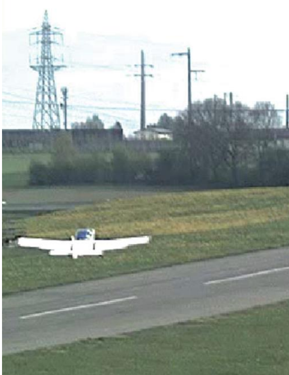
Figure 8: assiette: 14^\circ , inclinaison droite: 1.5^\circ , angle de 3.6^\circ à gauche de l'axe de piste 36.
