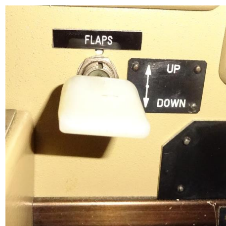
Figure 4: levier de commande des volets de courbure.
