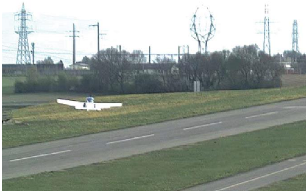
Figure 1: l'avion HB-HFK dans la montée initiale à 9 h 43 min 3 s avec une assiette à cabrer de 14°, une inclinaison à droite de 6° et le fuselage faisant un angle de 8.4° à gauche de l'axe de la piste 36.
