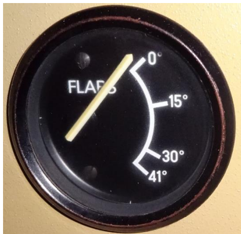
Figure 3: indicateur de position des volets de courbure.
