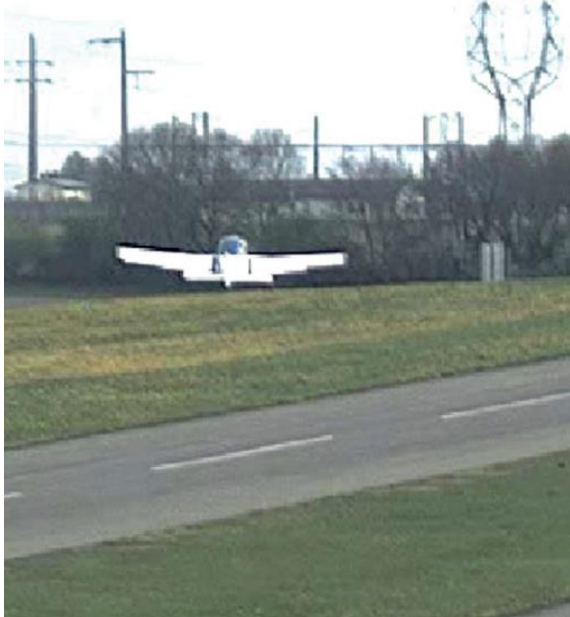
Figure 10: assiette: 14.5^\circ , inclinaison droite: 3.5^\circ , angle de 9.3^\circ à gauche de l'axe de piste 36.
