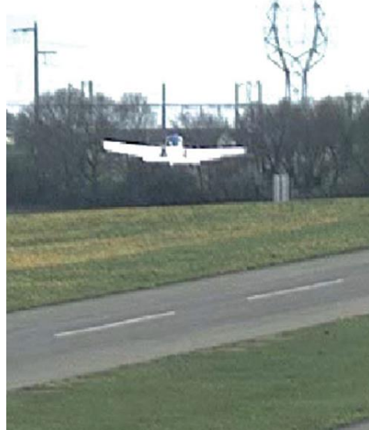
Figure 11: assiette: 14^\circ , inclinaison droite: 4.5^\circ , angle de 9.4^\circ à gauche de l'axe de piste 36.
