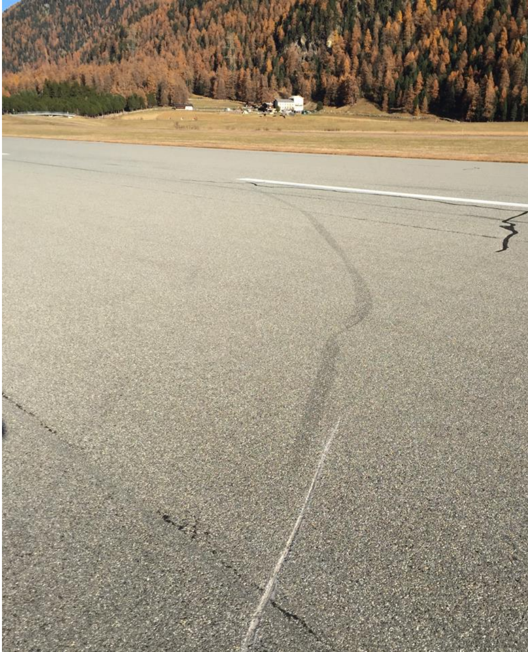
Abbildung 3: Spuren vom linken Reifen und der Radachse der HB-SEW
