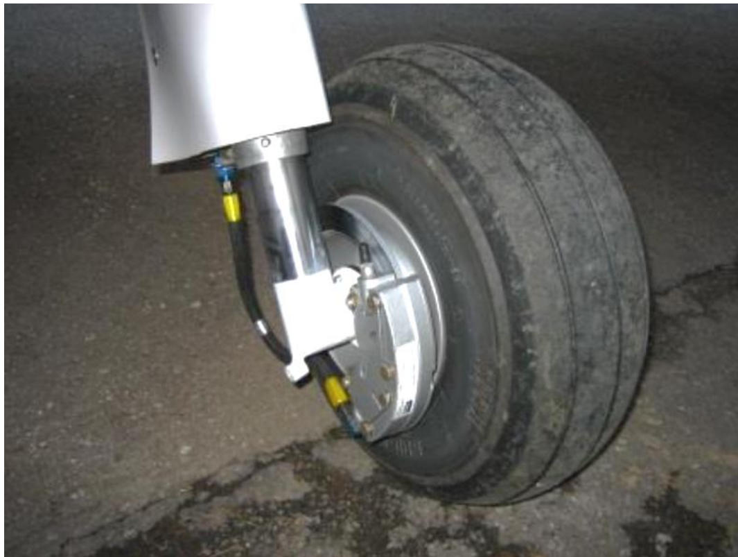
Abbildung 2: Aufnahme der Einzelradscheibenbremse der HB-SEW nach dem Umbau im Frühjahr 2015
