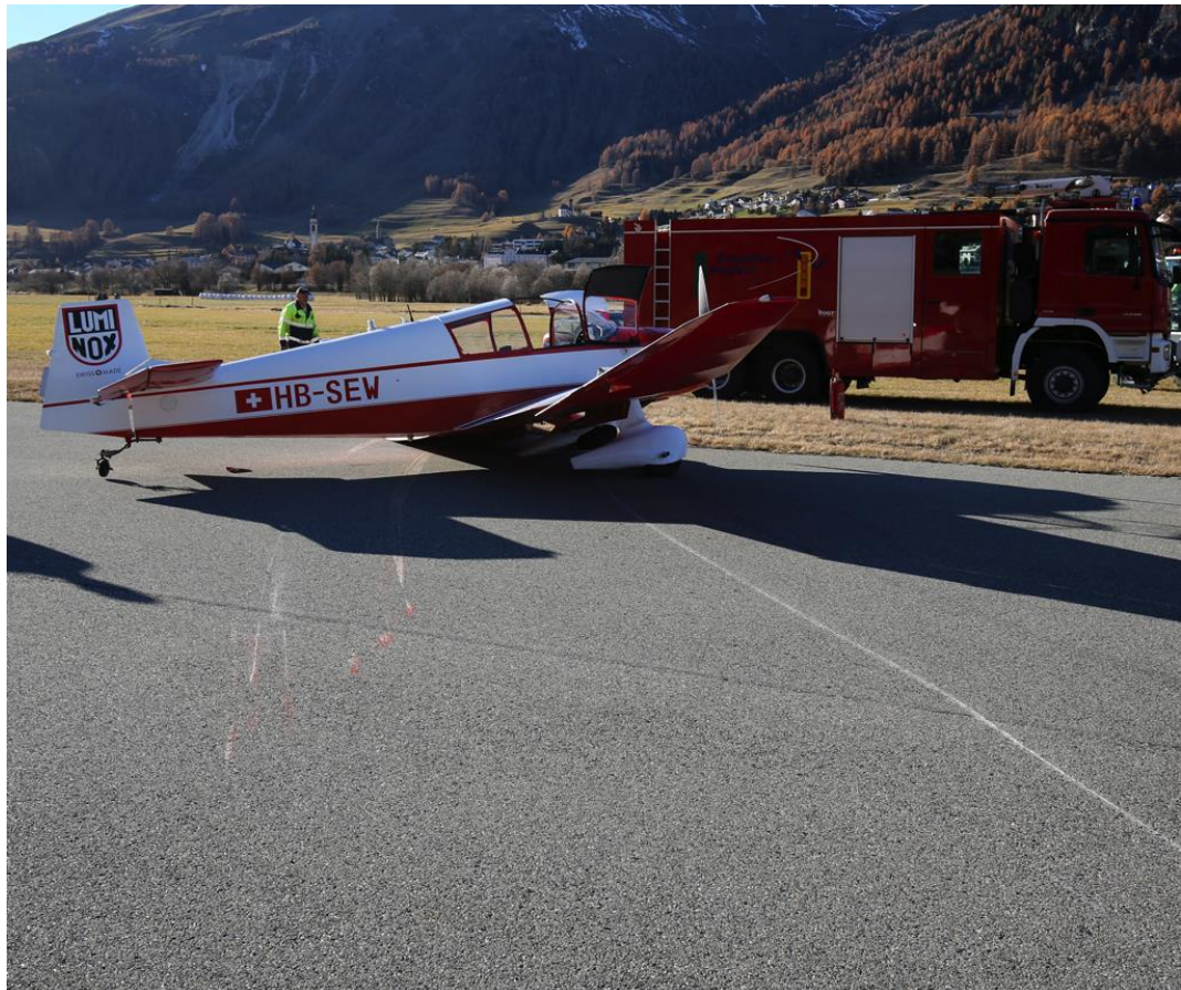
Abbildung 4: Spuren vom linken Flügel und vom linken Hauptfahrwerk der HB-SEW
