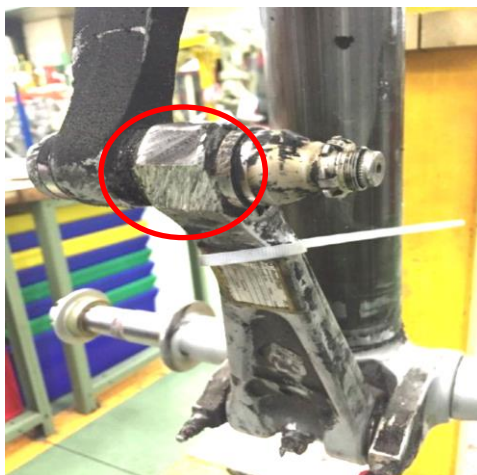
Abbildung 12: Beim Gelenk zwischen dem oberen und unteren Hebelarm ( torque link ) wiesen beide Gelenkaugen auf der untern Seite Schleifspuren auf.
