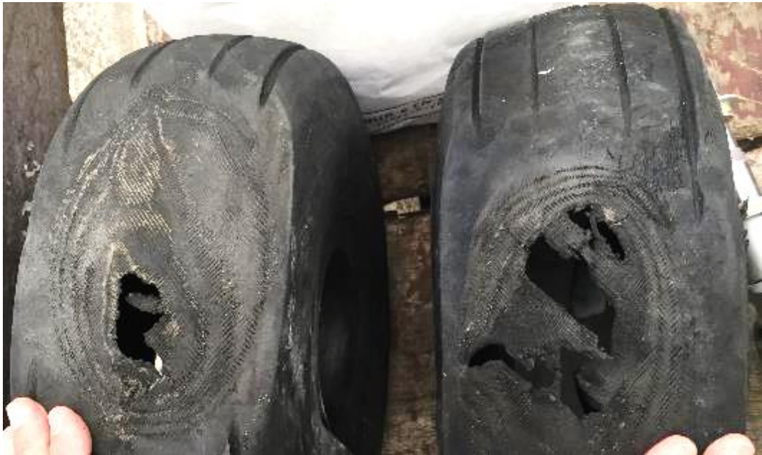
Abbildung 8: Abriebspur an den beiden Bugfahrwerkreifen der D-ANFE
