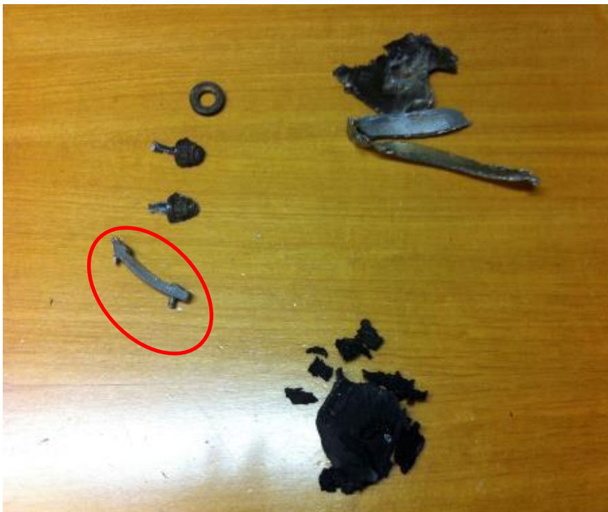
Abbildung 9: Auf der Piste 14 vorgefundene Kleinteile des Bugfahrwerkes
