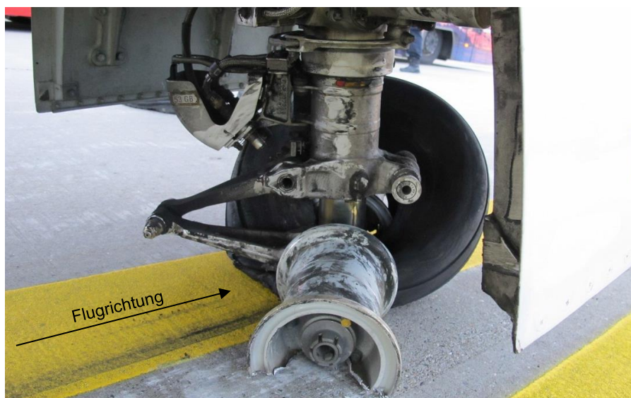
Abbildung 7: Schaden am Bugfahrwerk der D-ANFE nach der Landung; der linke Reifen blieb zwischen Felge, Fahrwerkbein und Achse eingeklemmt verkeilt.
