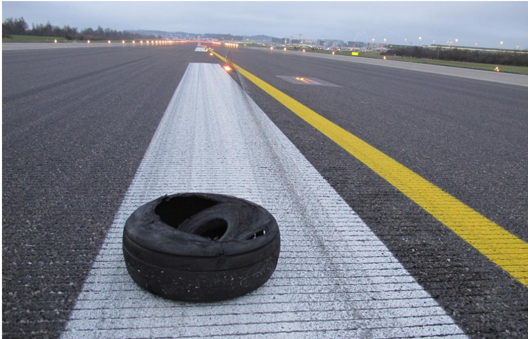
Abbildung 5: Anlässlich der Kontrolle der Piste 14 nach der Landung der D-ANFE wurde in ungefähr 2080 m Entfernung von der Pistenschwelle der Reifen des rechten Bugrades vorgefunden. Daneben sind weisse und schwarze Spuren sichtbar.
