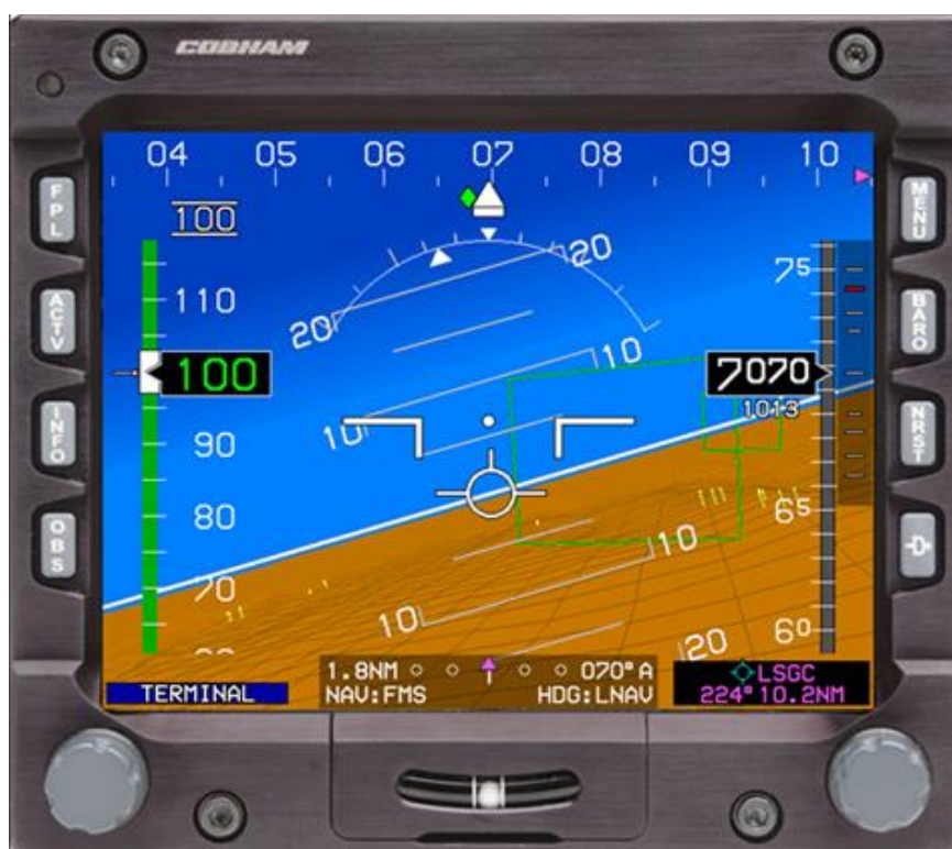
Figura 2: Rappresentazione tramite EFIS dei principali parametri di volo sul primary flight display (PFD) (rappresentazione schematica del costruttore, messa a disposizione dalla Rega).
