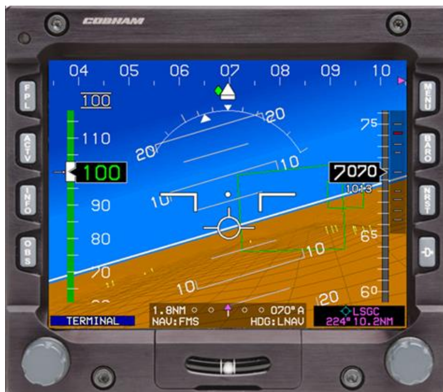
Abbildung 2: Darstellung der wesentlichen Flugparameter auf dem primary flight display (PFD) durch das EFIS (schematische Darstellung des Herstellers, zur Verfügung gestellt durch die Rega).
