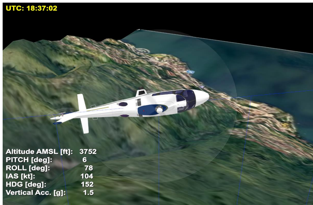
Abbildung 6: Momentaufnahme der 3-D-Animation auf Basis der EFIS-Daten um 20:37:02 Uhr bei maximaler Querlage ( bank ) von 78°
