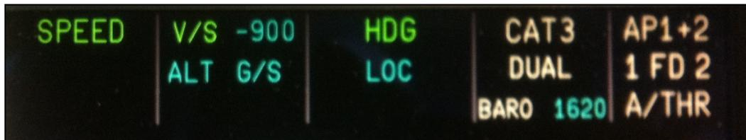
**Figure 7** : exemple de présentation de modes sur le FMA.
