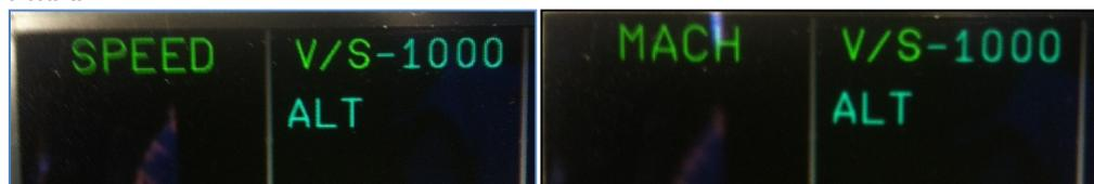
**Figure 9** : FMA en modes *speed / vertical speed* et *Mach / vertical speed* avec un taux de descente de 1000 ft/min.
