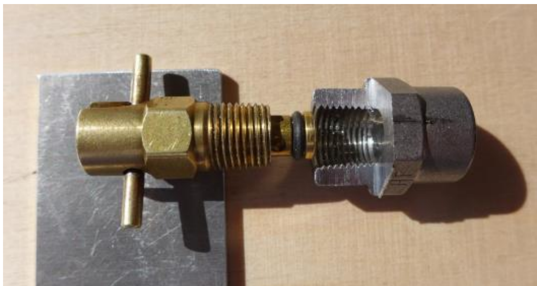
Abbildung 6: Ein neuwertiges drain valve in geöffnetem Zustand (links) neben dem zur Untersuchung aufgeschnittenen Anschlussstück der HB-PQS.
